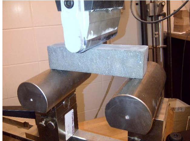
10. kép Hajlítás vizsgálat
