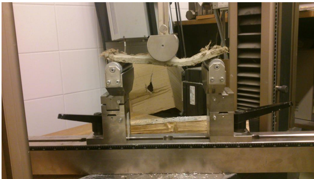
27. ábra Jutaszövetes elem törés közben
