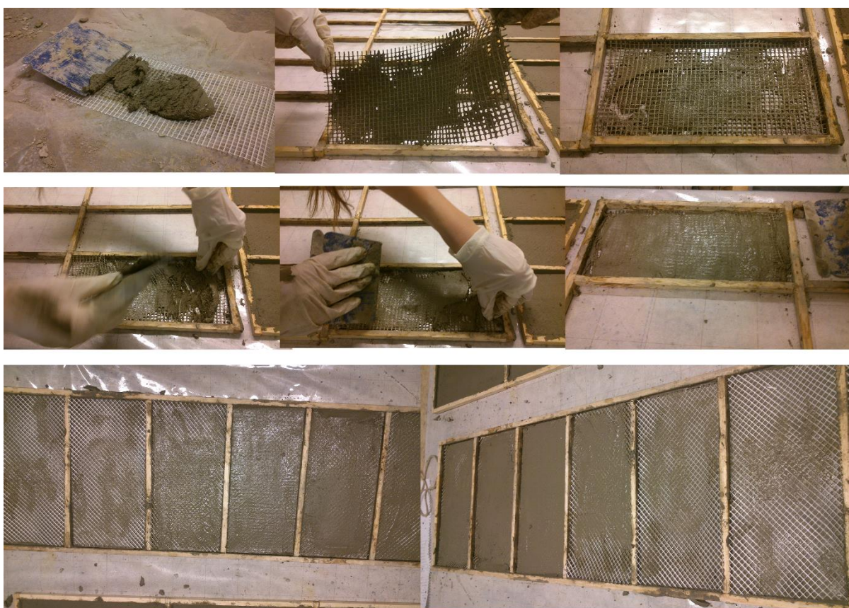
16. ábra Ferrocement lapok legyártásának folyamata
