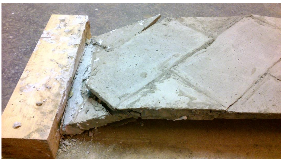
29. ábra Ferrocement boltív tönkremenetele
