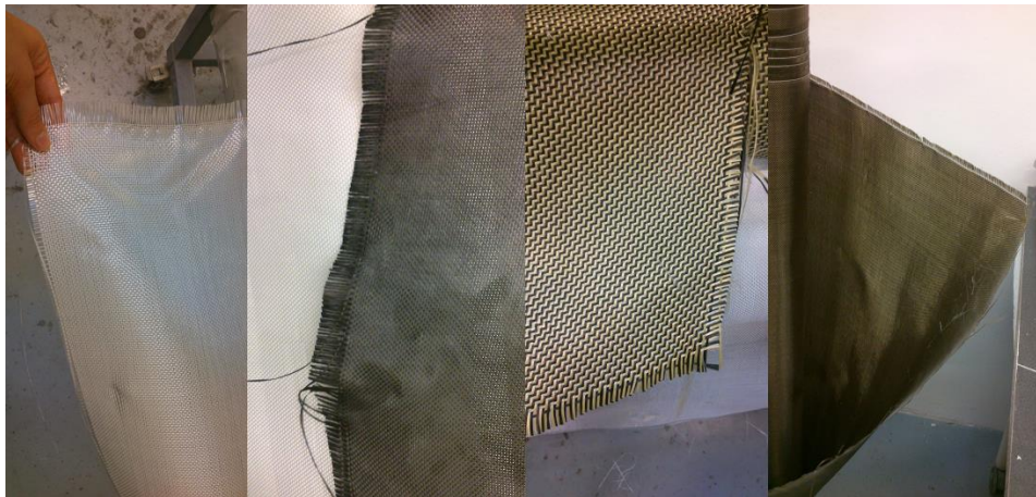
12. ábra Üveg-, szén-, aramid- és bazaltszövet
