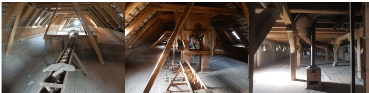
29. Központi magtár belső terében megtalálható felszerelés: csigahajtós fa vályú, fa csúszda és fa csövek
