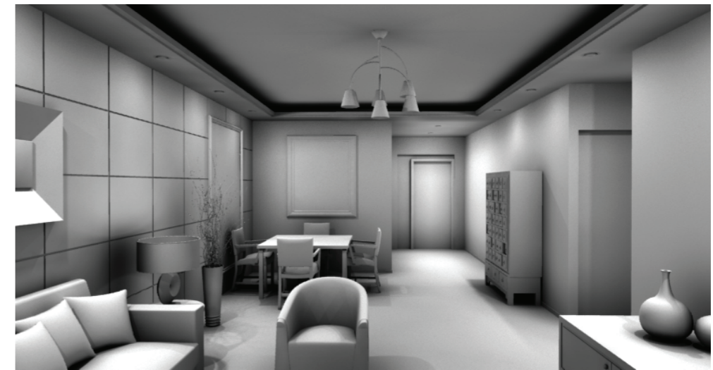
12. ábra. Lightmap. A felületeken ezt az előre számolt fényértékeket mutatja a kép.
