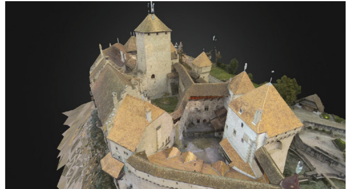
62. ábra. A chilloni kastély drónok által készített fotók alapján elkészített 3D modellje.
