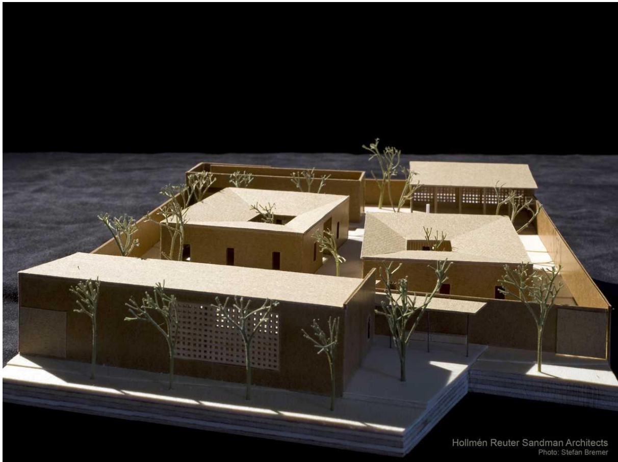
[Fig. 23] A Wolof és Chagga térszervezésének kombinációjából kialakult TunaHAKI terv makettje. Látható a fa köré szerveződés és a két egymással szembeálló lakóegység. A kiszolgáló funkciók a telek külső gyűrűjében kerültek kialakításra.
