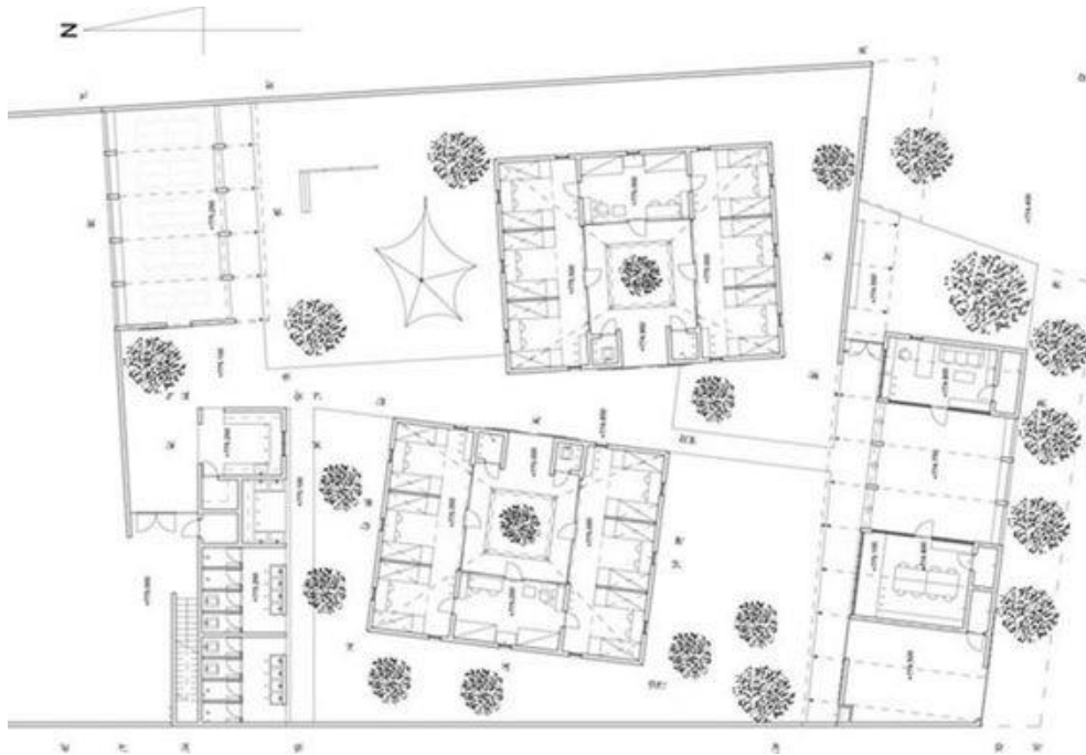
24. [Fig.] A Wolof és Chagga térszervezésének kombinációjából kialakult TunaHAKI terv alaprajza. Látható a fa köré szerveződés és a két egymással szembeálló lakóegység. A kiszolgáló funkciók a telek külső gyűrűjében kerültek kialakításra.
