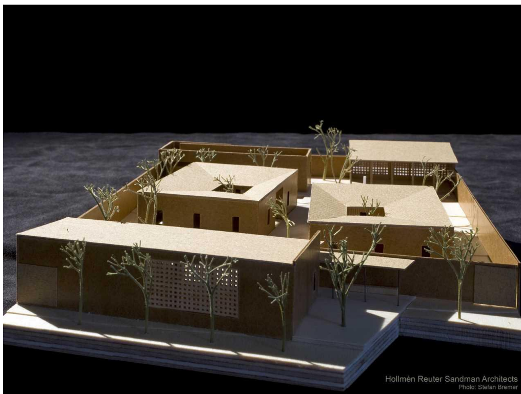
23. [Fig.] A Wolof és Chagga térszervezésének kombinációjából kialakult TunaHAKI terv makettje. Látható a fa köré szerveződés és a két egymással szembeálló lakóegység. A kiszolgáló funkciók a telek külső gyűrűjében kerültek kialakításra.
