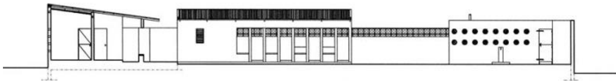
11. [Fig.] Metszet és homlokzat. Látható a magas védelmi funkciót ellátó udvari fal, a magasított lábazati kialakítás, a túlnyúló eresz, továbbá látható lábazati 40cm-es kiemelés is. Az kép jobb oldalán fekete körökkel jelölve, a mellékhelyiségek autófelnivel takart szellőzőnyílásai látszanak.
