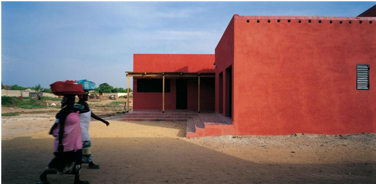
[Fig. 16] A Women's House esetében is megfigyelhető a kifelé zárt tömegalakítás. A nyílások kevés száma a Nap elleni védelmet is jelenti. Továbbá látható lábazati 40cm-es kiemelés is.
