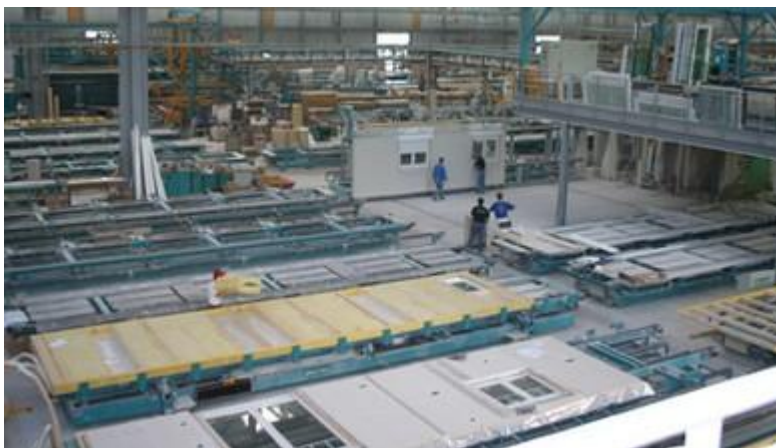
24. ábra Nagypanel gyártócsarnok
