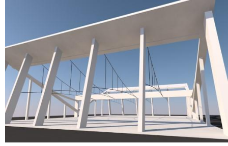
30.kép: a szerkezet modellje, szelemenek nélkül
