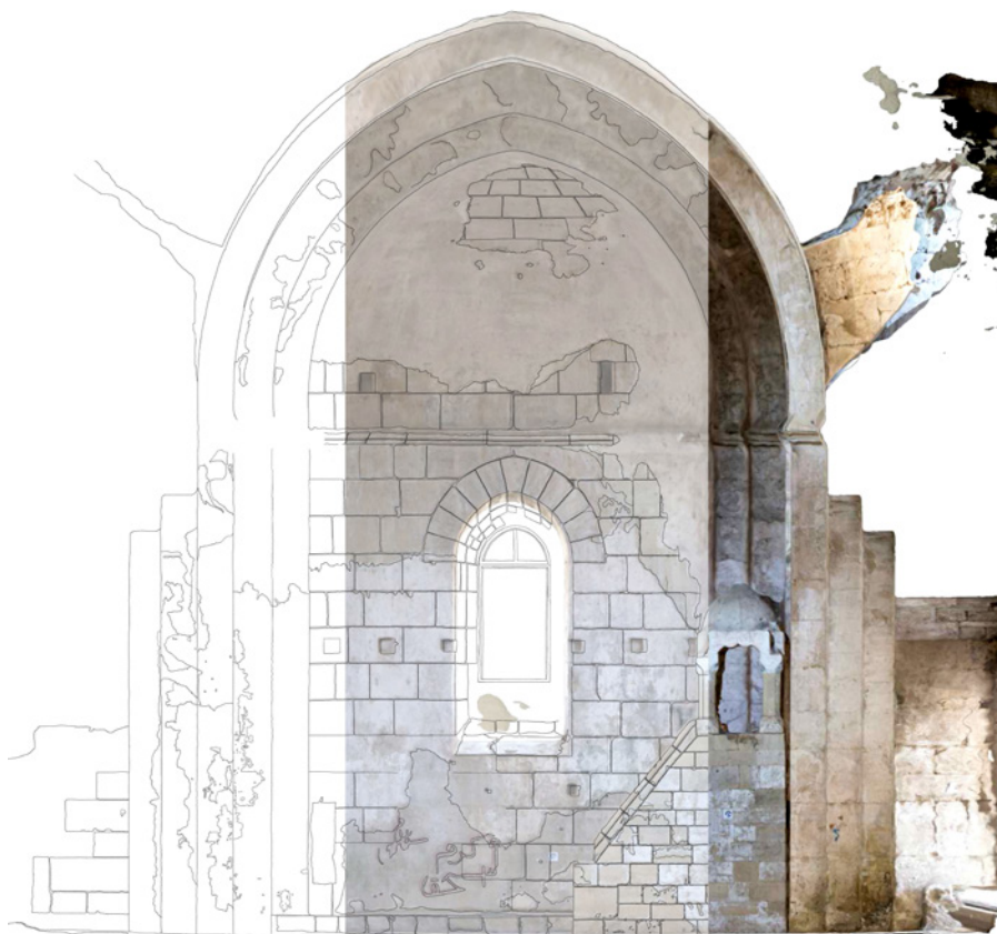
57. ábra. A előző szezonban készült modell nézete az előfeldolgozás során elkészült rajzokkal, keresztmetszet
