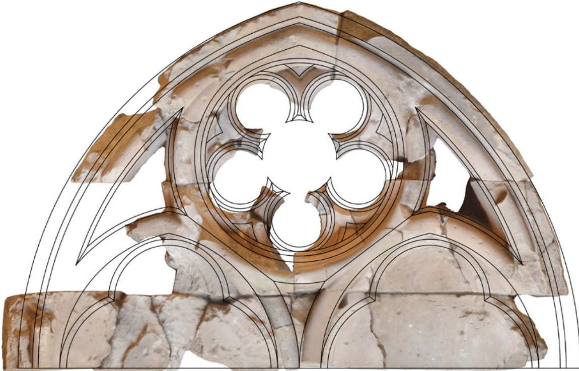
Fent: 30. ábra. A helyszínen összerakott mérmű modelljének nézete és az AutoCAD-es szerkesztés
