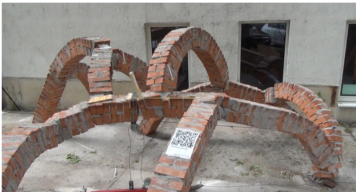
[f.18.] szerkezet a tönkremenetel pillanatában
