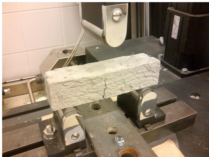
6. kép: Mikroszál adalékanyagú próbatest hajlítása a beton berepedése után
