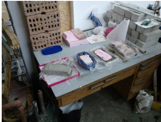
8. kép: Próbaöntések a zsaluzattól való elválaszthatóság tesztelésére
