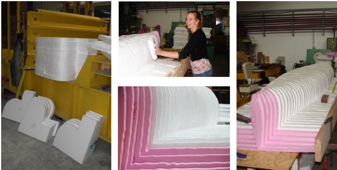
7. képsor: Képek a zsaluzat elkészítéséről
