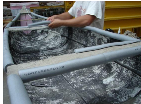
5. kép: Peremerősítés (polifoam csővel védve) és keresztborda
