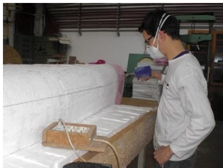
12. kép: Hosszborda kialakítása forrasztópákával
