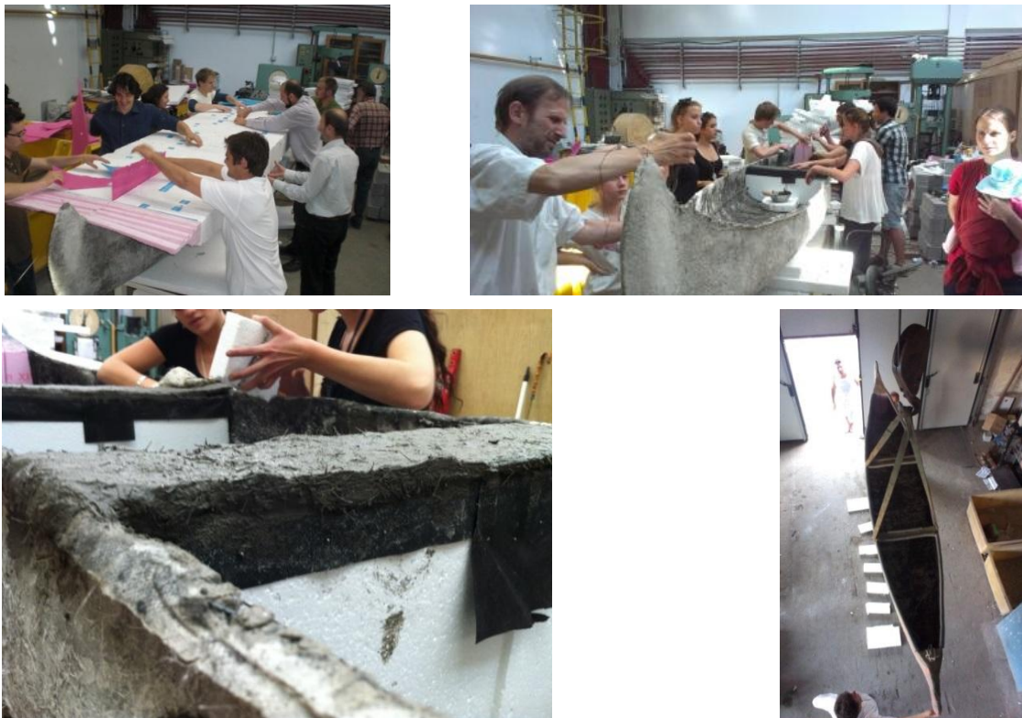
14. képsor: Képek a zsaluzat eltávolításáról, az összekötő bordák betonozásáról és a kenu mozgatásáról
