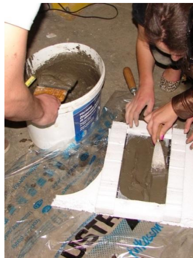
10. kép: Próbatest készítése egy réteg csirkeháló és két réteg műanyag háló erősítéssel
