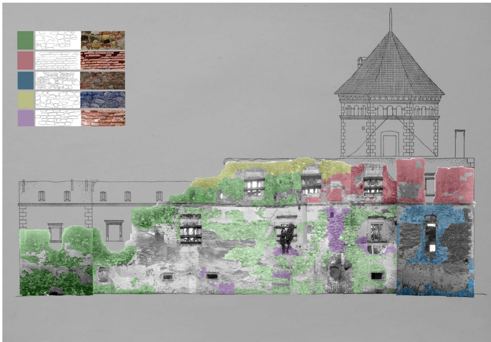
2. ábra Az aranyosmeggyesi kastély északi homlokzatának "falazási mintái". Az ábra alapja: BME Építészettörténeti és Műemléki Tanszék Rajz-és Fotótára [102416]
