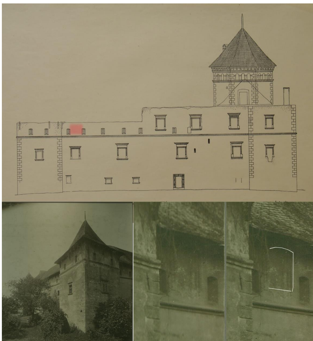
60. kép Egykori ablak helye az aranyosmeggyesi kastély északi homlokzatán. BME Építészettörténeti és Műemléki Tanszék Rajz-és Fotótára [102416], BME Építészettörténeti és Műemléki Tanszék Rajz-és Fotótára [801271]
