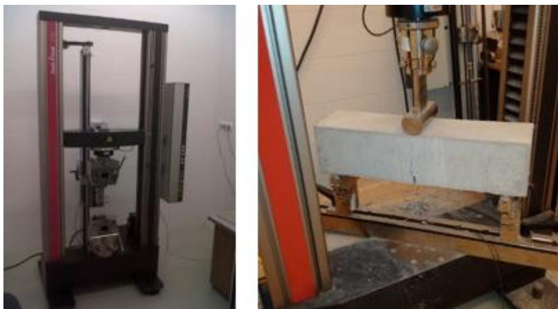
4. ábra: Fotó – ZWICK/ROELL Z150 univerzális anyagvizsgáló gép
