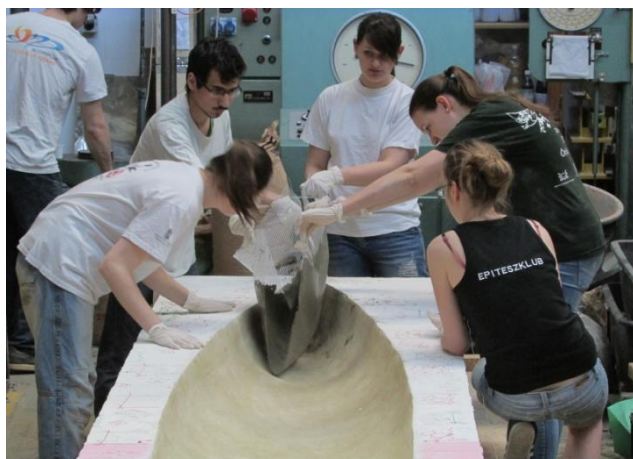
6. kép: A betonnal bevont üvegszövet háló beemelése a formába
