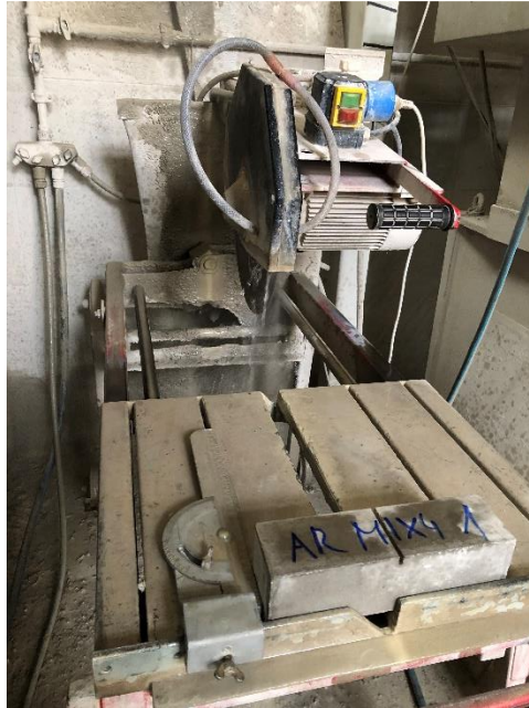
7.5. ábra Betonvágó és bevágott próbatest
