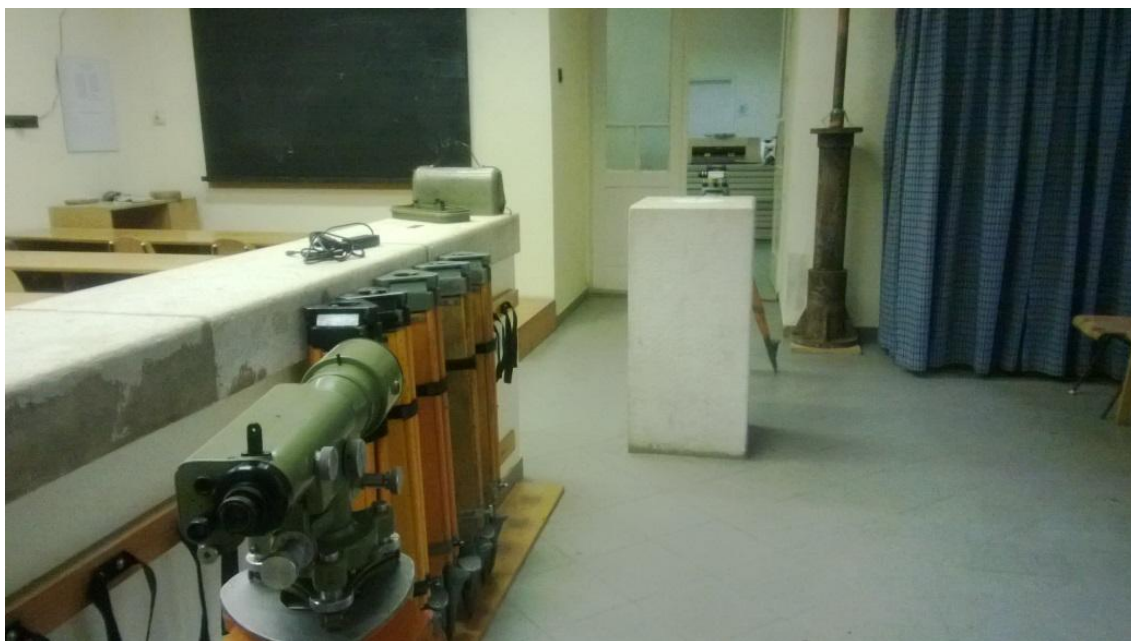
21. ábra: A kamera tokozatának átvetíése a Wild N3-as felsőrendű szintezőműszerrel
