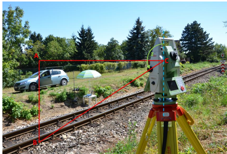
8. ábra: Trigonometriai magasságmérés szemléltetése
