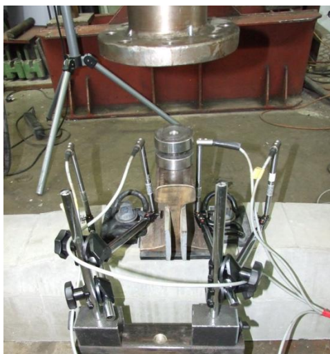
24. ábra "0" jelű, aljlapucs nélküli betonalj vizsgálati elrendezése
