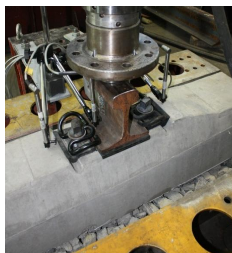
24. ábra "0" jelű, aljlapucs nélküli betonalj vizsgálati elrendezése
