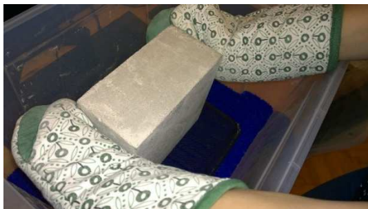
11. ábra a minták elhelyezése légzáró dobozban
