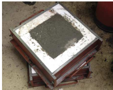
4. ábra Betonozott födémrészlet
