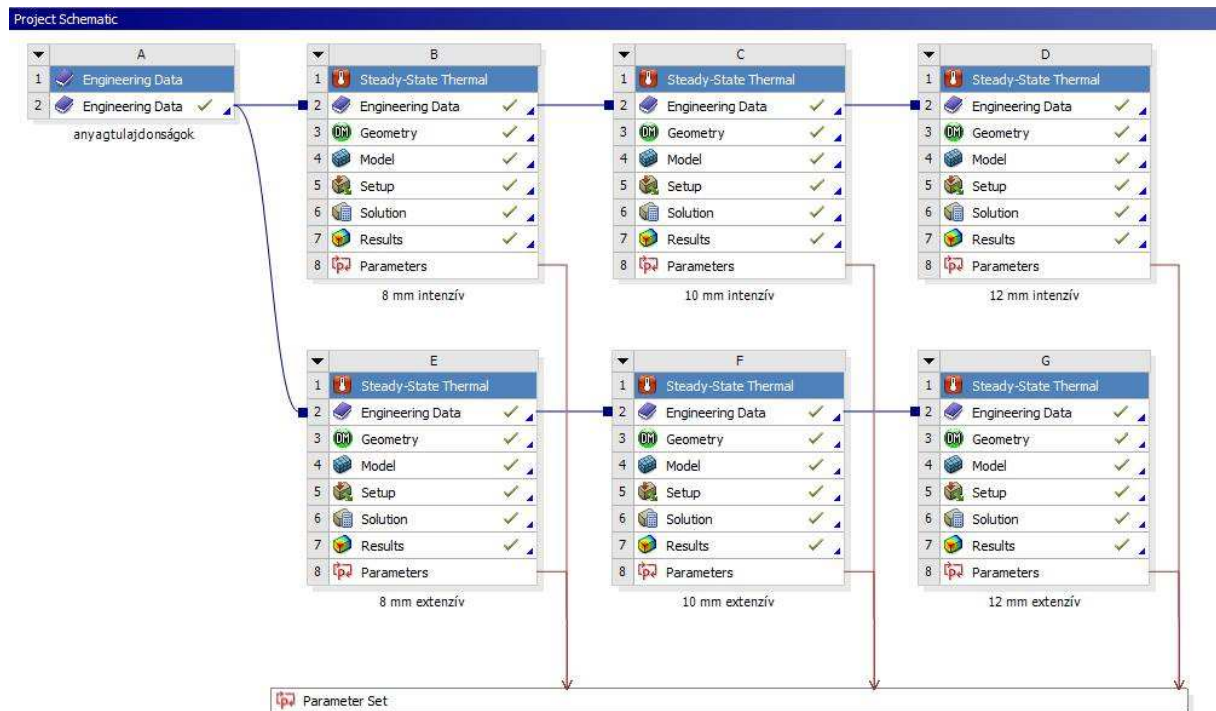
38. ábra Ansys szimulációs programba a megtervezett intenzív és extenzív 6x6 m-es 3 féle vasátmérővel bevasalt födémek
