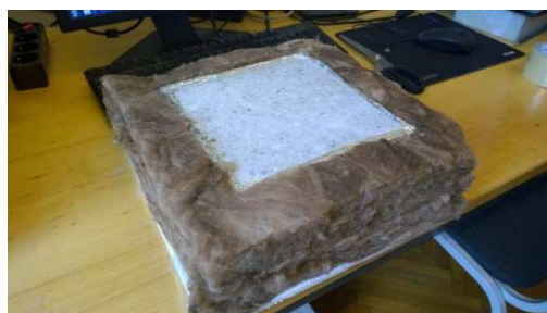
15. ábra Üvegyapot kalodába helyezésük
