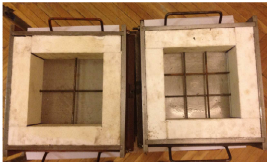
3. ábra zsalu készítése
