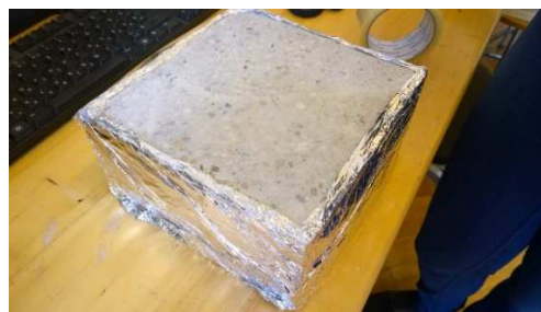
14. ábra A minták bevonása alufóliával
