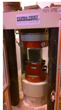
8. ábra Betonkockák törése
