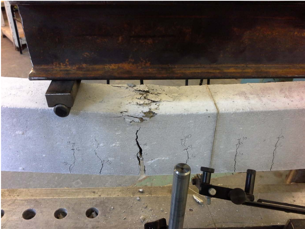
4. kép: Az alulvasalt gerenda tönkremenetele
