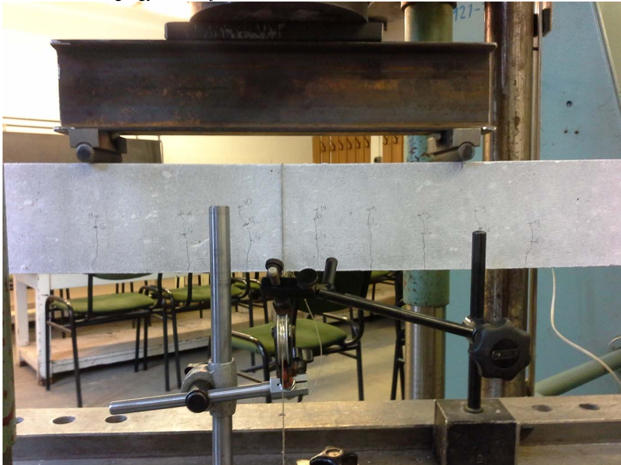
3. kép: Alulvasalt gerenda repedésképe
