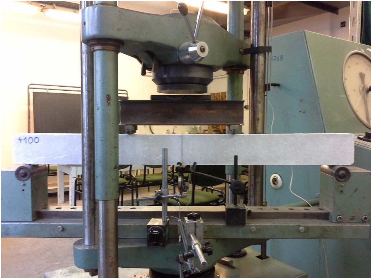
1. kép: A kísérleti gerenda terhelő berendezésben való elhelyezkedése és a teher elrendezés
