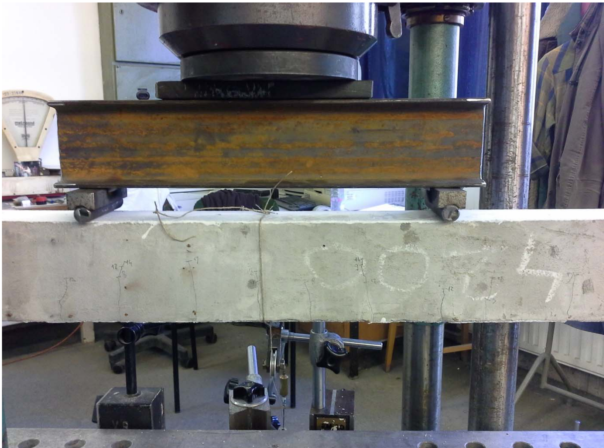
8. kép: Normálvasalású kísérleti gerenda repedésképe
