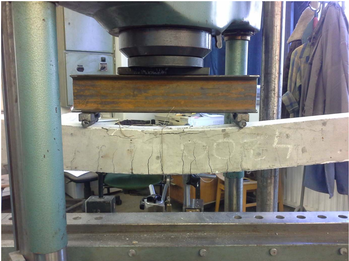
6. kép: Normálvasalású gerenda tönkremenetele
