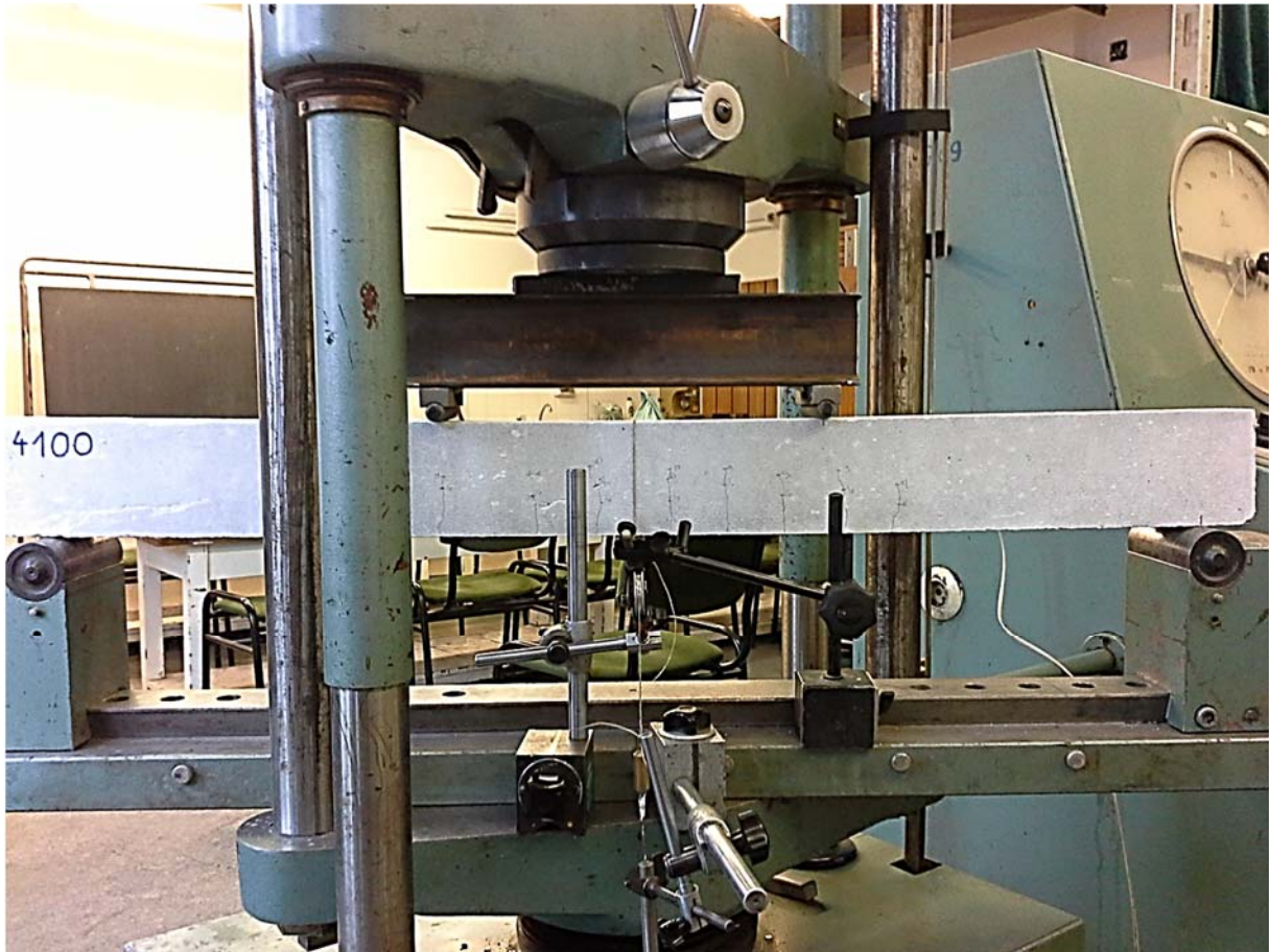
7. kép: Alulvasalt kísérleti gerenda repedésképe
