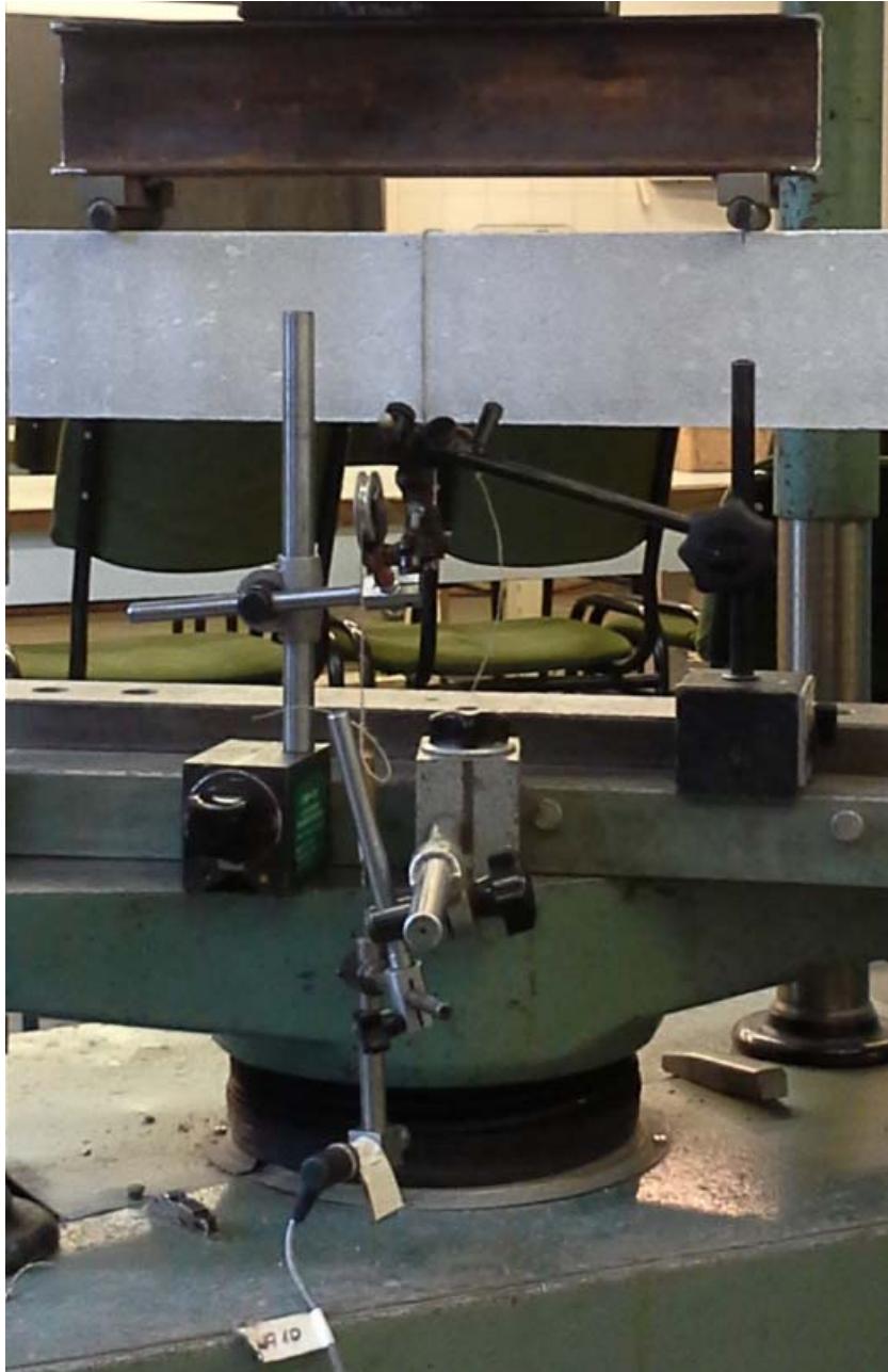
2. kép: Az induktív elmozdulás mérő elhelyezkedése
