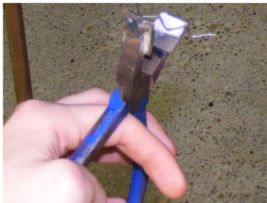
3.46 ábra: Szál elhelyezése a speciális fogóban
