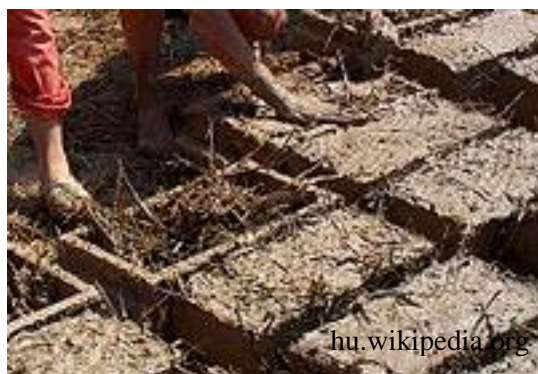
2.2 ábra: Vályogtéglák készítése
