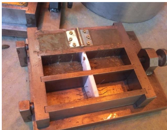
4.2 ábra: Zsalu előkészítése
