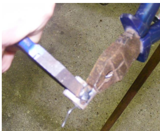
3.48 ábra: Szál másik szélő hullámának kialakítása
