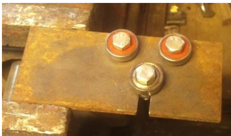
3.5 ábra: A csapágysor elrendezése
