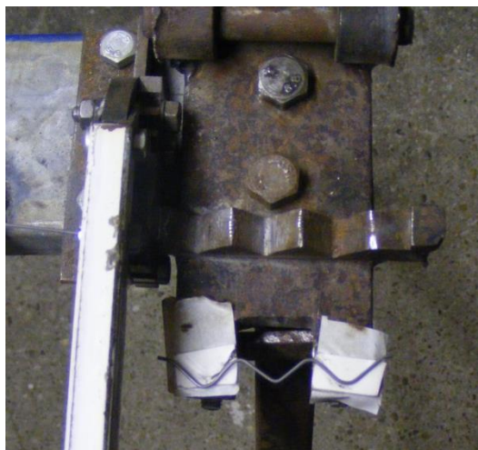
3.37 ábra: Szál elhelyezése a megmunkáló vállakon
