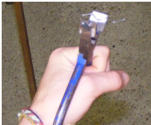
3.55 ábra: Szál elhelyezése a speciális fogóban
