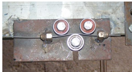
3.6 ábra: Az egyengető csapágysor működés közben
