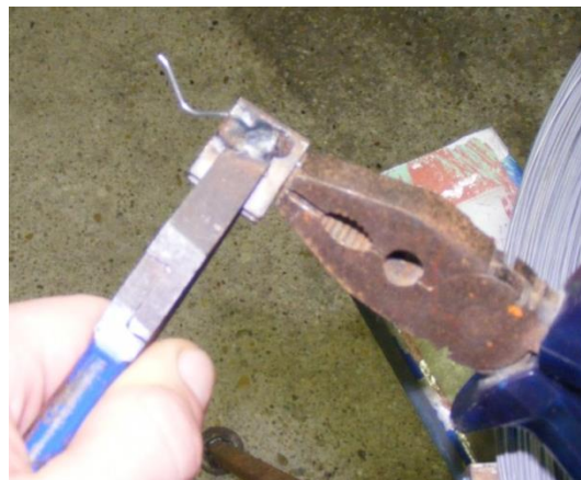
3.56 ábra: Szál egyik szélső hullámának kialakítása
