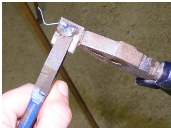
3.47 ábra: Szál egyik szélő hullámának kialakítása
