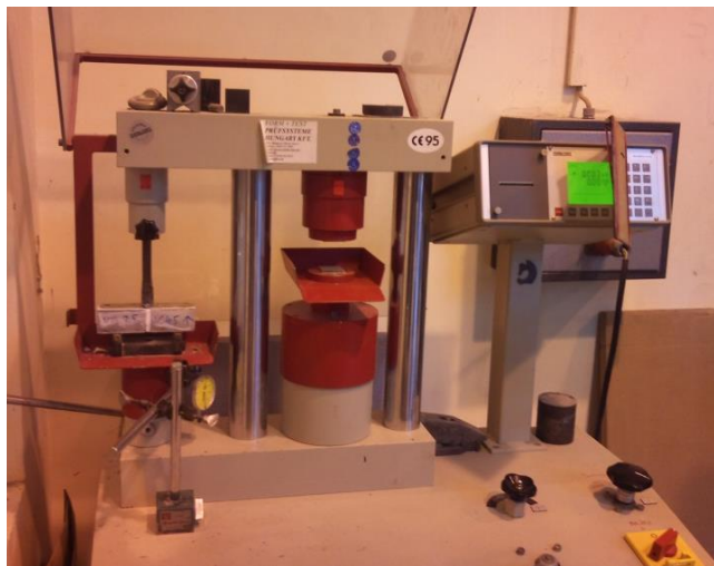
4.4 ábra: Hárompontos habarcs hajlító gép
