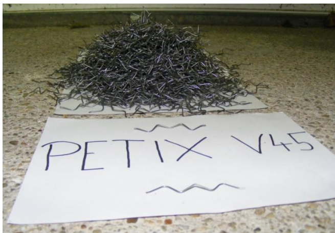
3.25 ábra: A közel 2000 darab PETIX V45 típusú acélszál
