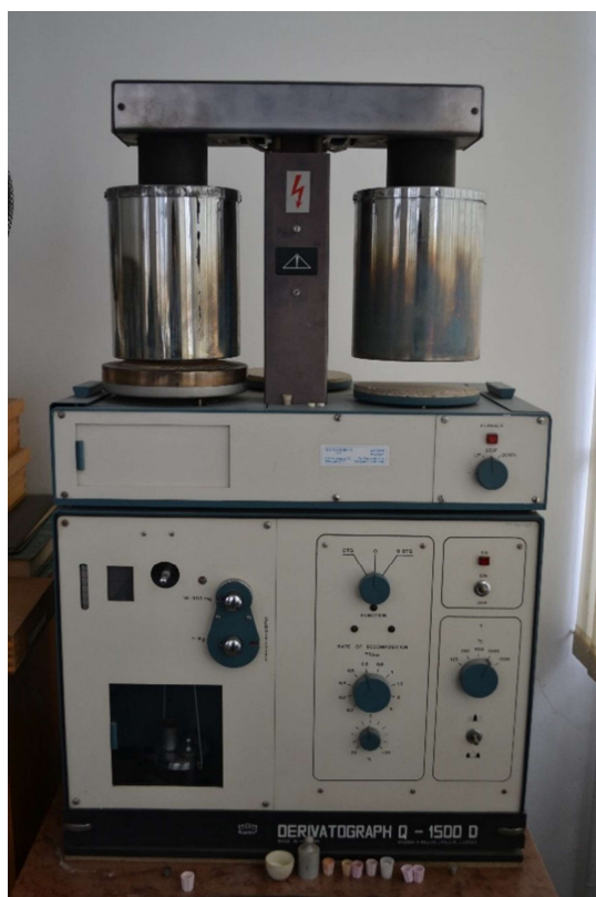
3.7. ábra: Derivatograph Q-1500 D kísérleti berendezés
