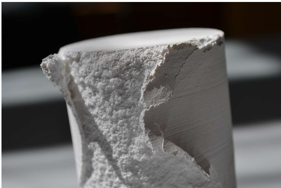
4.5. ábra: Márvány felületi rétegének leválása nyomószilárdság méréséhez készített próbatesten
