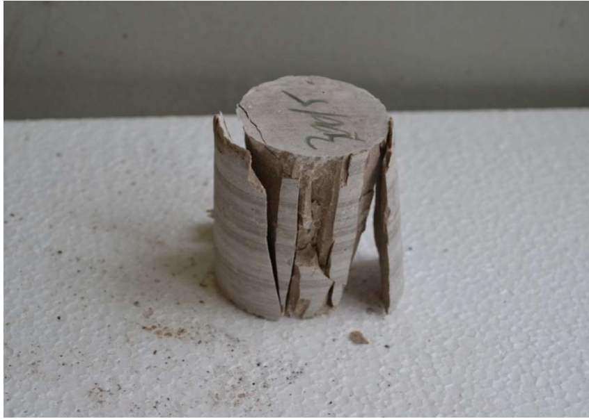
4.18. ábra: Mészkeő próbatest törésképe (300 °C)
