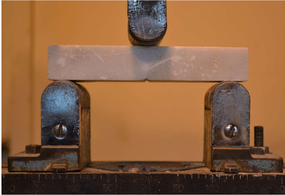
3.5. ábra: Kísérleti elrendezés a hajlító-húzószilárdság vizsgálatánál
