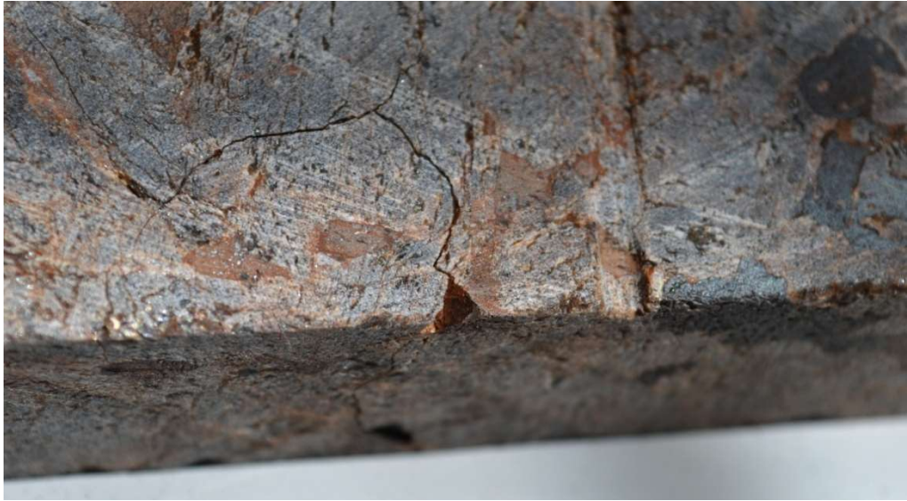
4.2. ábra: Kőzetek repedezettsége (labradorit)
