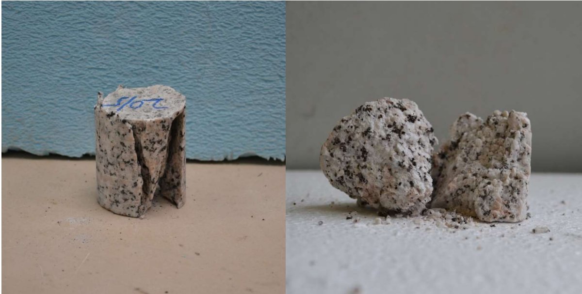
4.10. ábra: Gránit próbatest törésképe 20 °C 4.11. ábra: Gránit próbatest törésképe 800 °C
