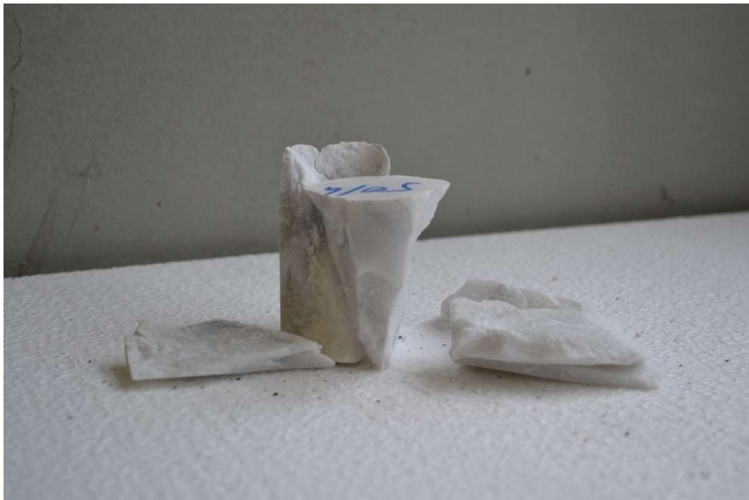
4.19. ábra: Márvány próbatest törésképe (50 °C)
