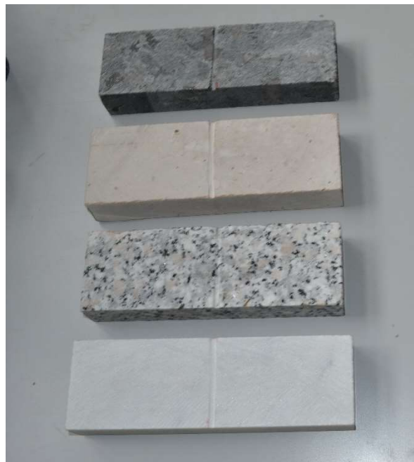
3.2. ábra: Bemetszés a hajlító-húzó szilárdság méréséhez kialakított próbatesteken
