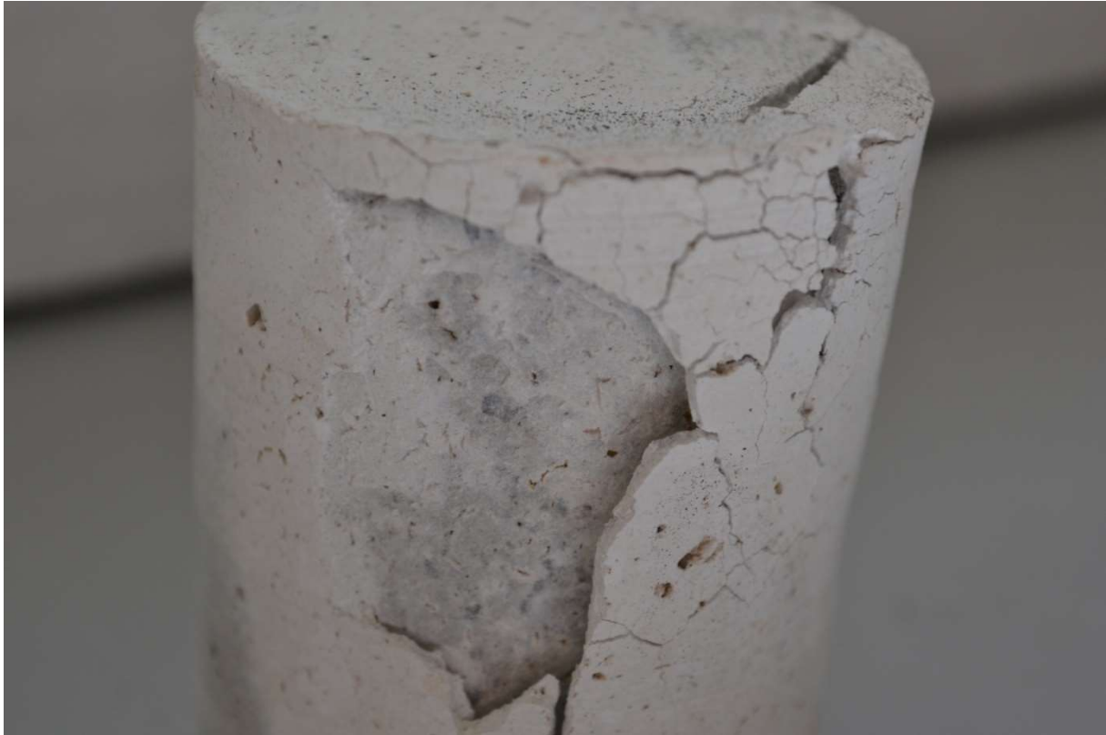
4.7. ábra: Mészke felületi rétegének leválása nyomószilárdság méréséhez készített próbatesten
