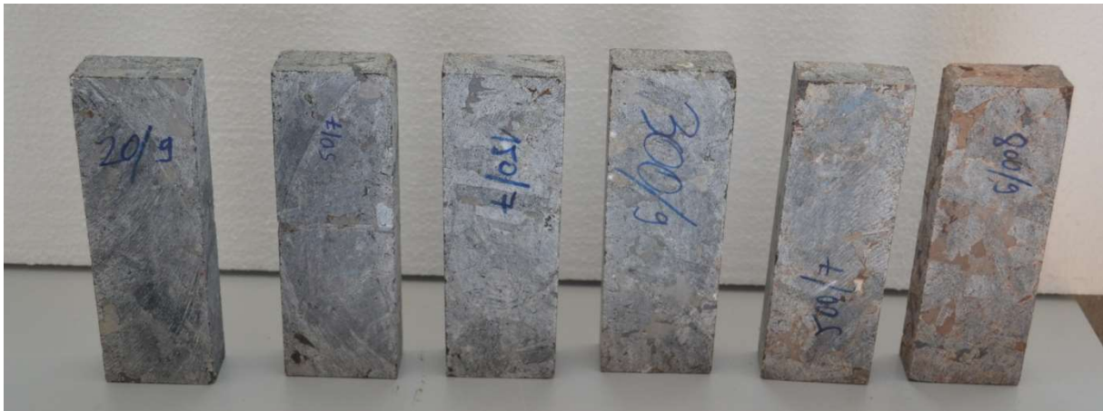
4.3. ábra: Labradorit próbatestek vas tartalmú ásványainak oxidációja okozta színváltozás
