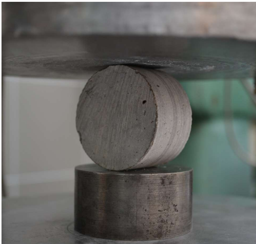
3.6 ábra: Kísérleti elrendezés a hasító-húzószilárdság vizsgálatánál
