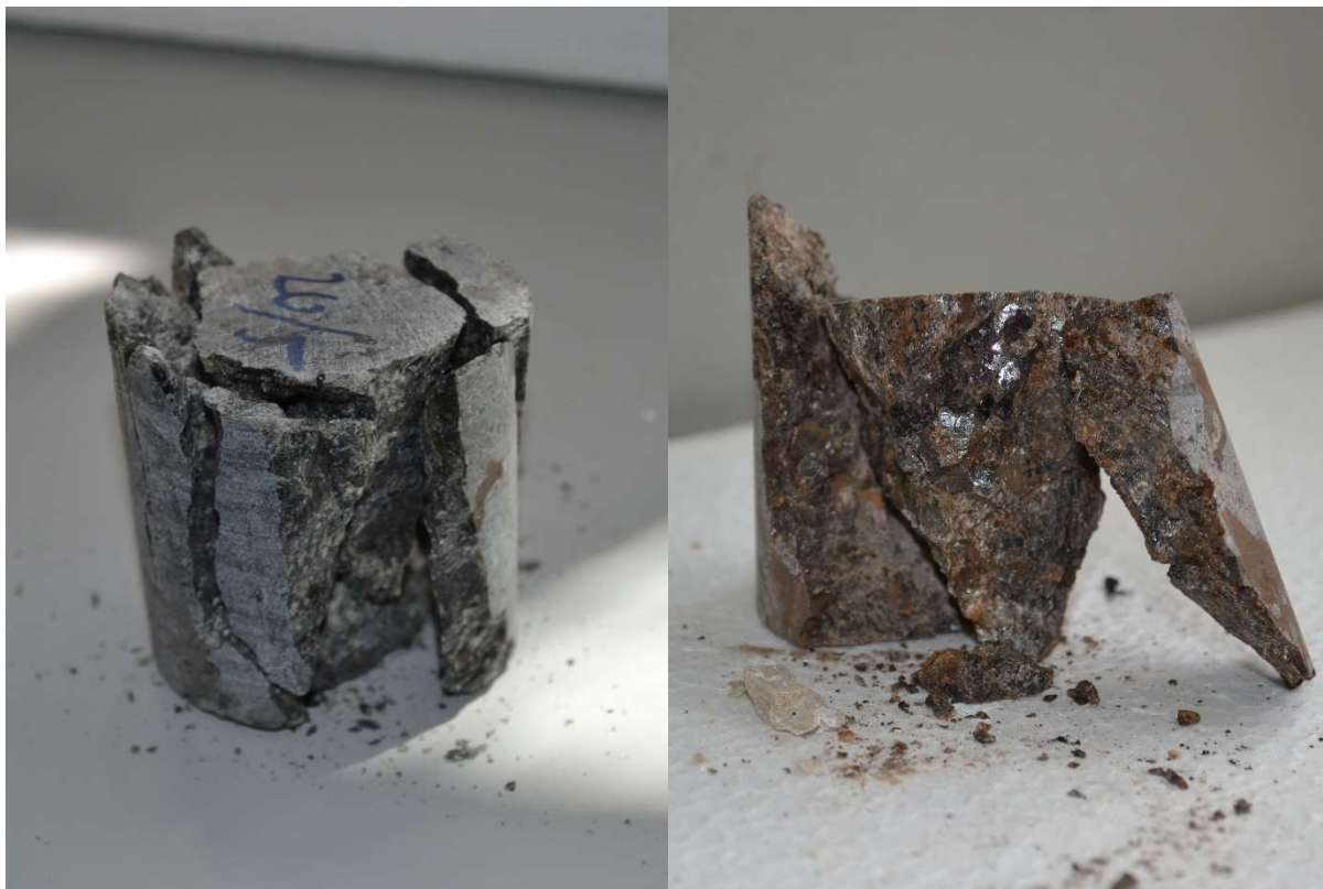
4.14. ábra: Labradorit próbatest törésképe 20 °C 4.15. ábra: Labradorit próbatest törésképe 800 °C
