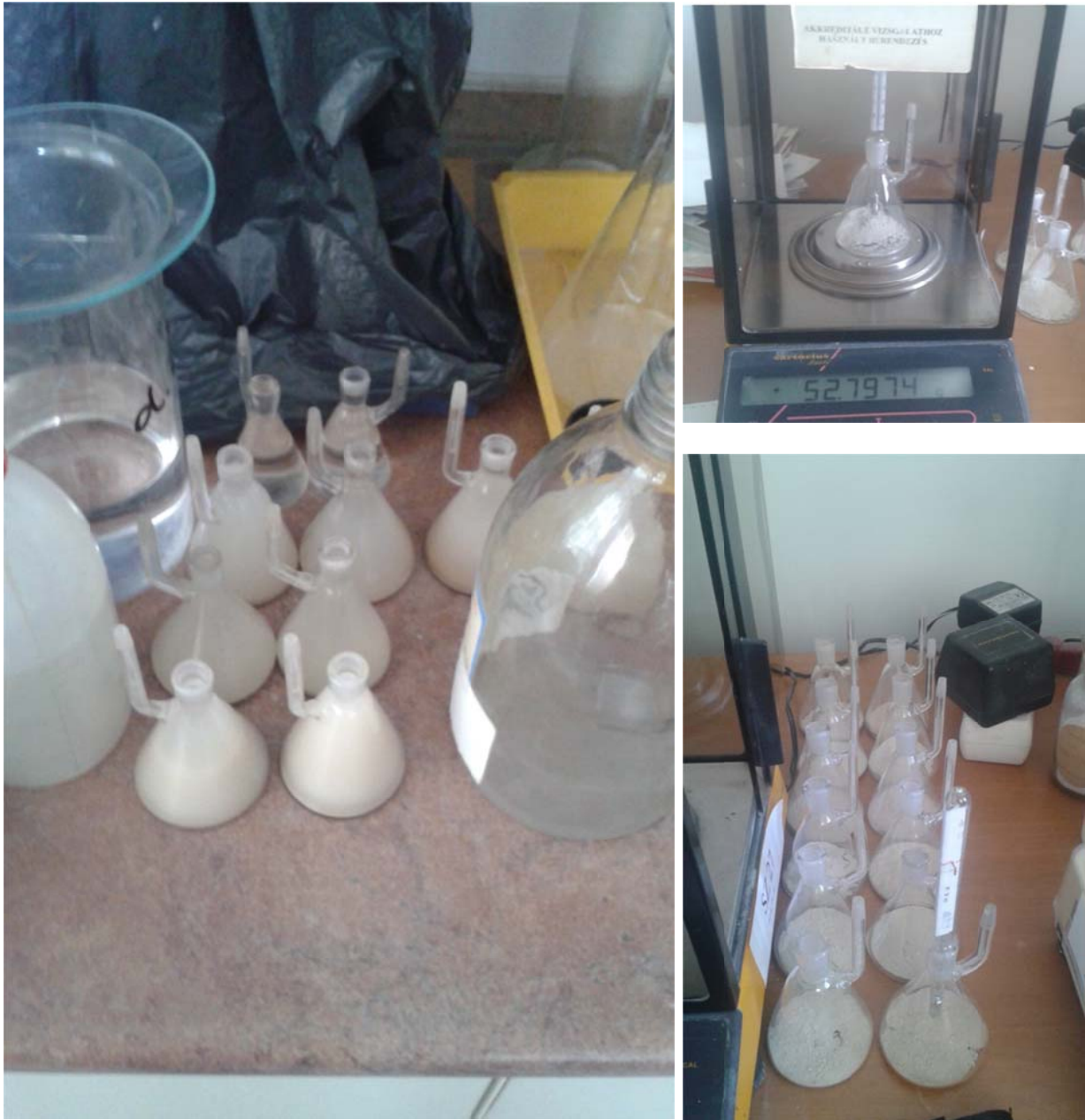
12. ábra Piknométeres vizsgálat egyes lépései
