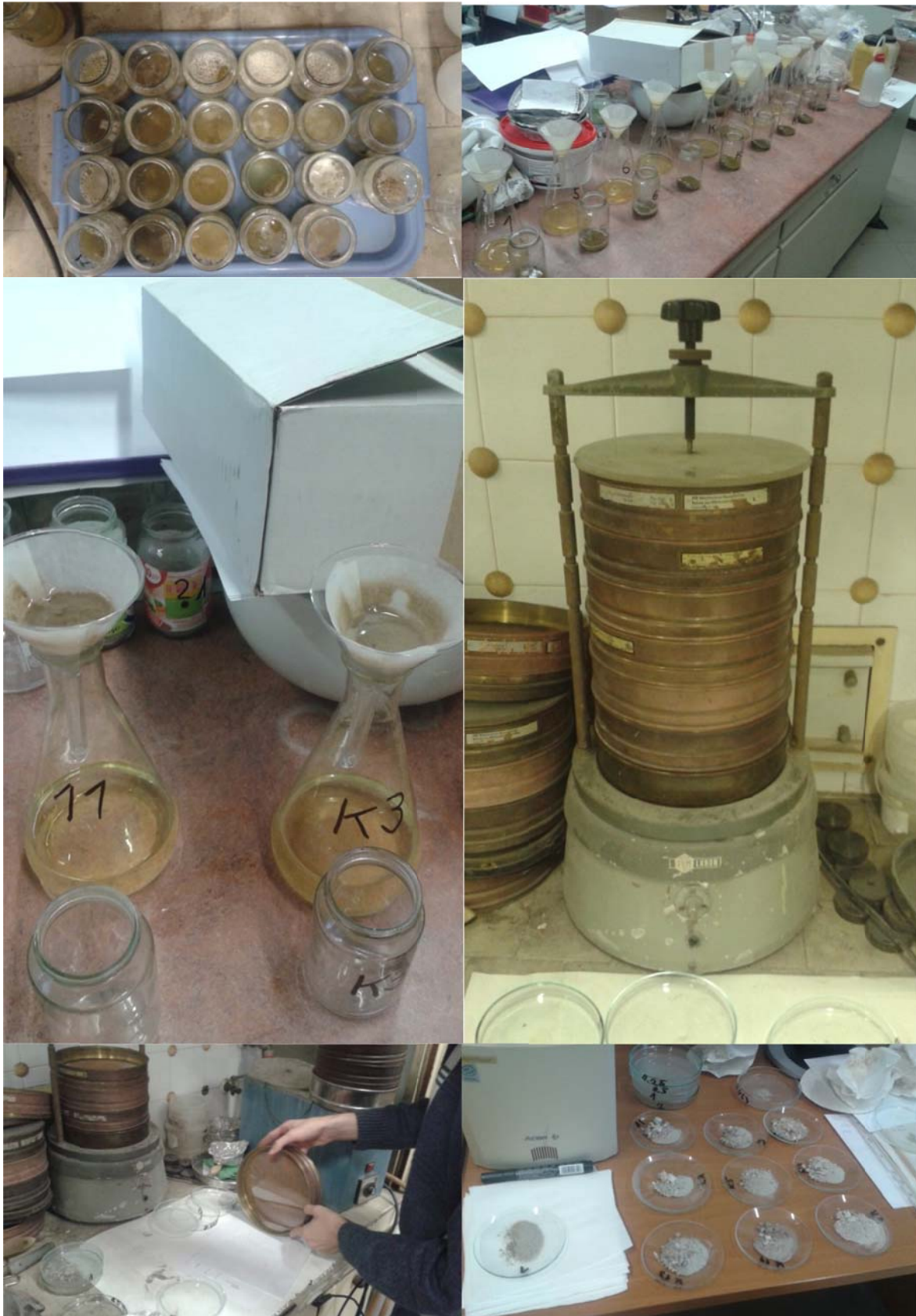
14. ábra A szemeloszlás vizsgálat lépései
