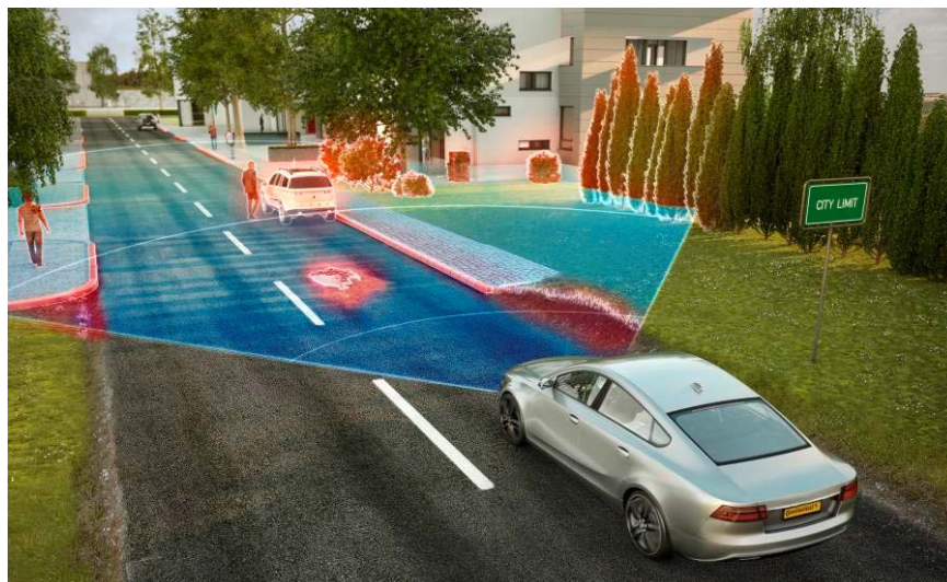
10. ábra: A jármű környezetében a radar által érzékelt objektumok [ https://www.autonomousvehicletech.com ]
