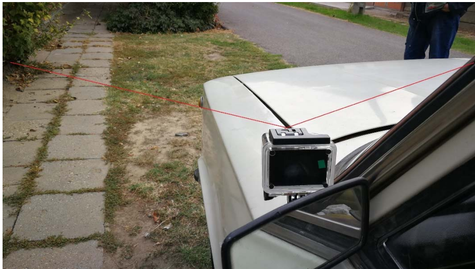
20. ábra: A szélső elhelyezésből adódóan a kamerák látómezője növelhető
