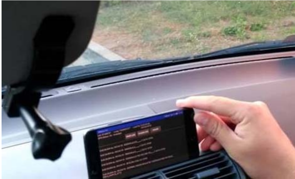
17. ábra: NMEA adatok rögzítése mobiltelefon segítségével
