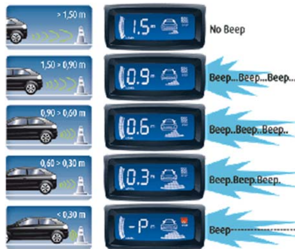
9. ábra: Tolatóradar működése [ http://www.vezetesorome.com ]
