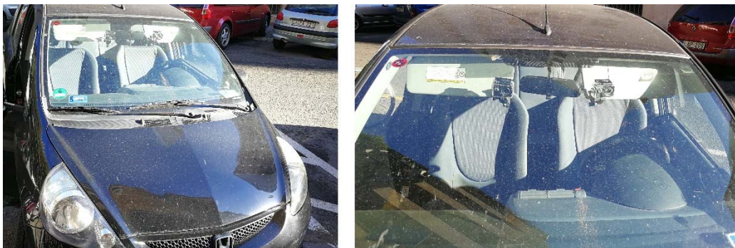
18. ábra: Utastérben, szélvédő mögött elhelyezett kamerák
