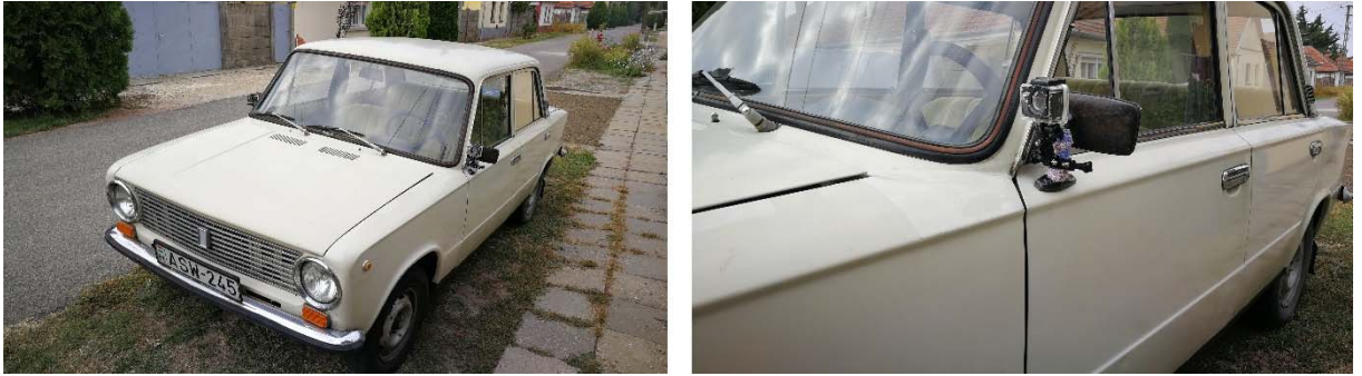
19. ábra: Oldalsó visszapillantó tükrökön elhelyezett kamerák
