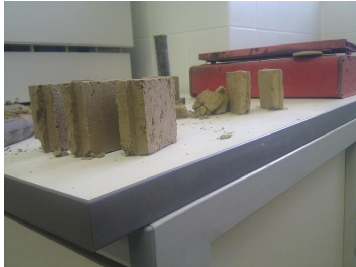
4.7. kép Különböző terhelésekkel elnyírt minták
