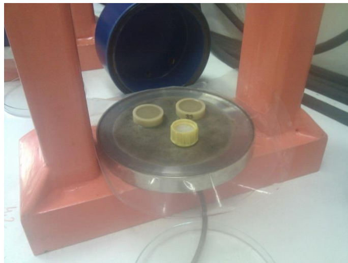
4.4. kép pF 4,2 szívás értékhez tartozó készülék, a gyűrűbe kanalazott mintákkal
