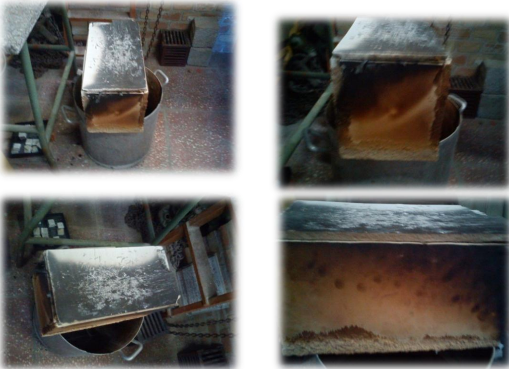
4.1. ábra: A tűzterhelés által okozott külső sérülések
