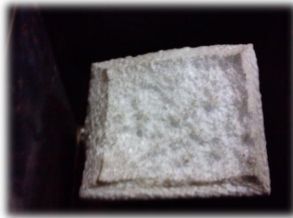
4.42. ábra: Az élei mentén zsugorodó EPS
