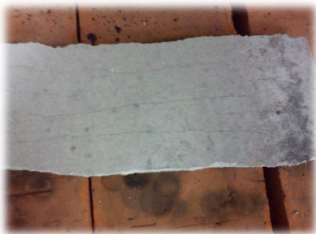
4.25. ábra: Hálós repedések
