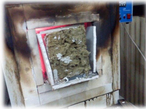
4.24. ábra: A szétesőben lévő próbadohoz
