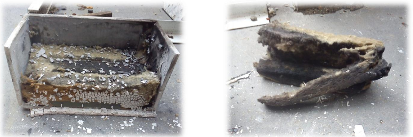
4.11. ábra: Az elszíneződött szigetelés a próbatest alatt illetve felett
