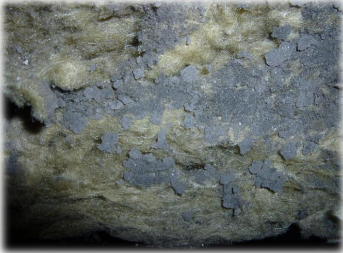
4.21. ábra: Sértetlen kőzetgyapot rátapadt elszínesedett papírral
