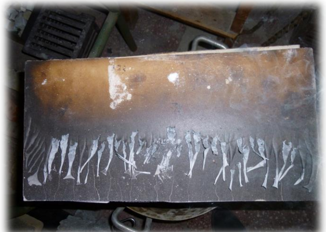
4.19. ábra: Égett papír a próbadohazon
