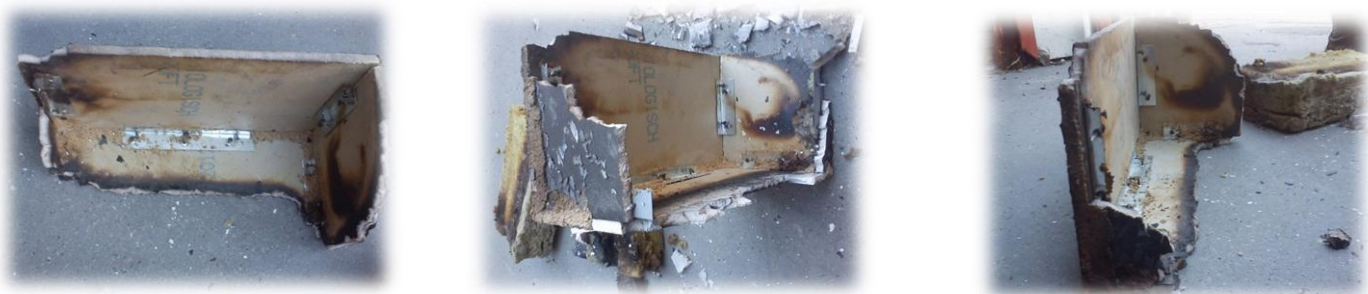
4.4. ábra: A roncsolódott próbadoboz
