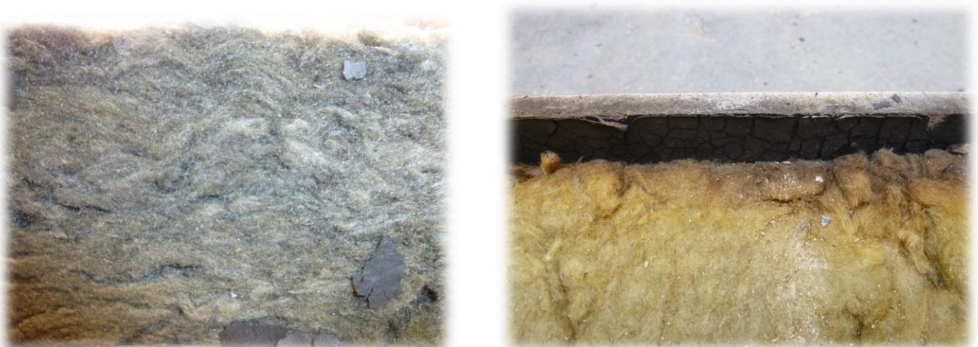
4.36. ábra: Sértetlen, de elszíneződött kőzetgyapot
