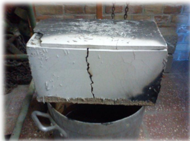
4.2. ábra: A függőleges repedés
