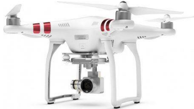
5. ábra DJI Phantom 3 drón. A hasán jól megfigyelhető a méréseinkhez felhasznált kamera a hozzátartozó gimballal.
