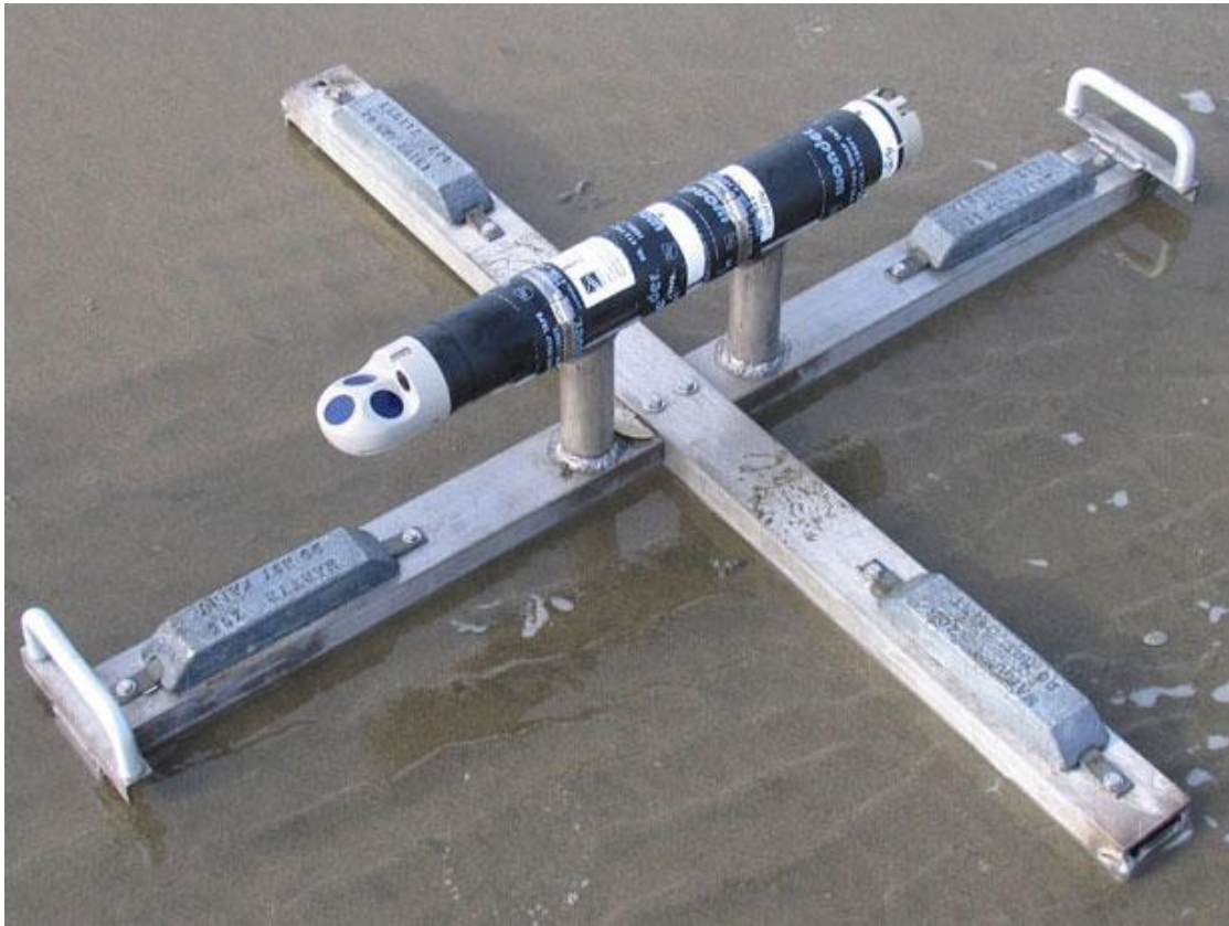
7. ábra San Francisco partjainál az óceán hullámadatainak mérésére előkészített Aquadopp Profiler 1MHz készülék. A kép https://soundwaves.usgs.gov/2006/04/ oldalról származik, ahol az Egyesült Államok Földrajzi Kutatóközpontjának (USGS) szakemberei által végzett kutatásokról számolnak be.
