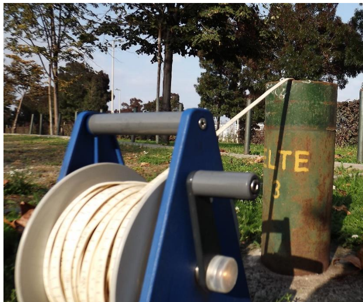
5. kép: Mérés az ELTE 3-as kúton. A leolvasás a kút peremén történik
