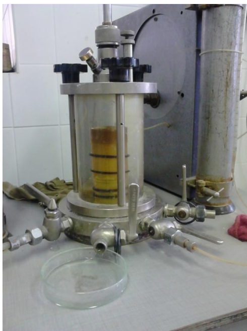
5.6 fénykép: Áteresztőképesség mérése triaxiális készülékben
