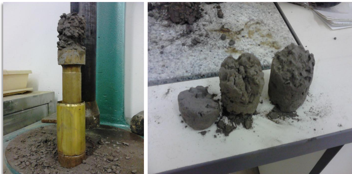
5.8 fénykép: Kis szilárdságú próbatestek nyomószilárdság mérés előtt
