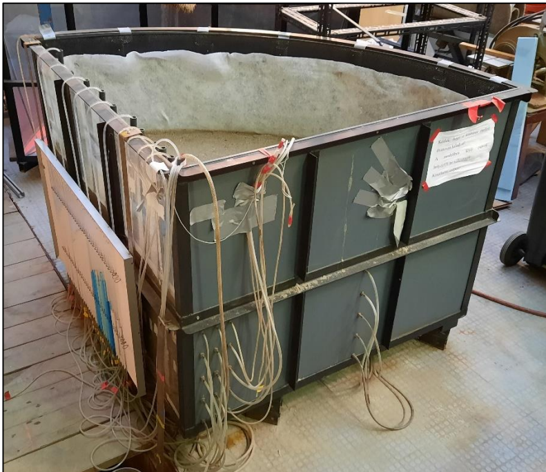
1. kép: A laboratóriumi kismintamodell
