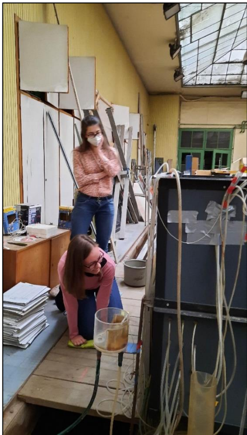
6. kép: Vízszintek leolvasása a piezométertábláról
