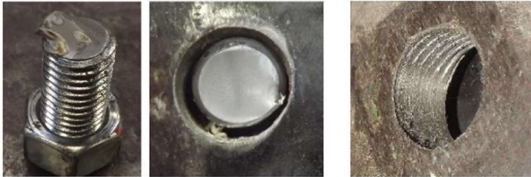
3.4. ábra: Próbatetek tönkremenetelének képei [6]
