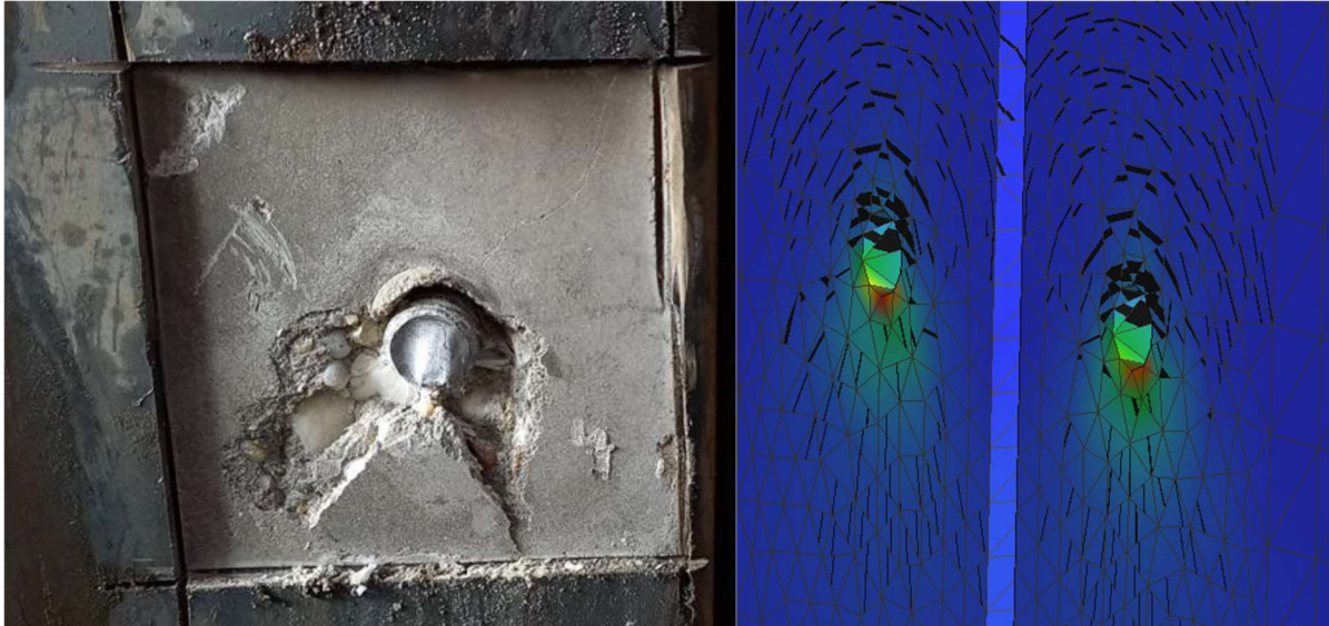
6.10. ábra: Beton alakváltozásainak és morzsolódásainak összehasonlítása
