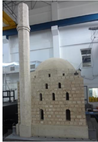
11. ábra – Mustafa Pasha mecset Szófia: valós szerkezet, kisléptékű és numerikus modell
