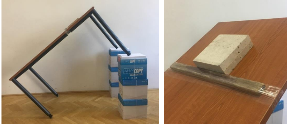
23. ábra – Súrlódási szög mérése kísérlettel
