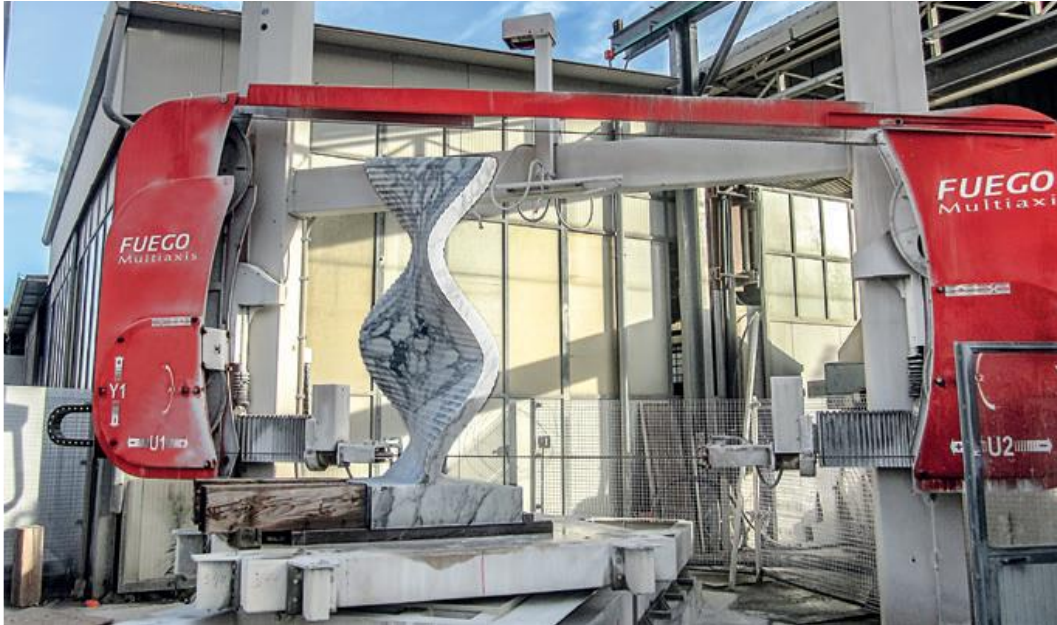
2. ábra – Többtengelyű huzalfűrészelő és az általa létrehozott kőoszlop. [3]
