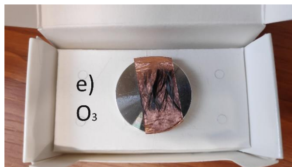
4. ábra: A minták arannyal történő gőzölés előtt: a) REF.0, b) REF.1 mosott, c) 3.1 nitrálsavval kezelt szobahőmérsékleten, d) 3.2 nitrálsavval kezelt melegen, e) ózonnal kezelt minta
