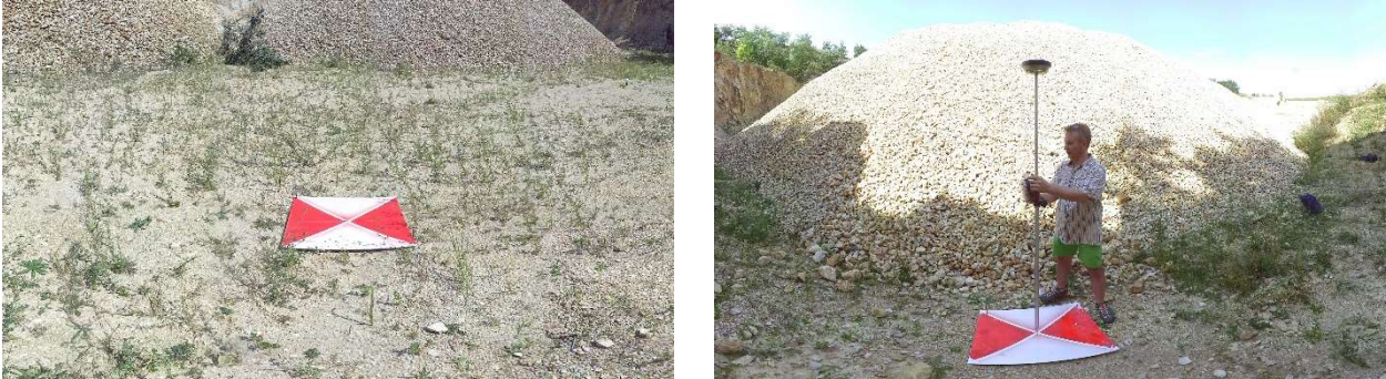
6. ábra: Balra egy földön elhelyezett kapcsolópont, jobbra egy hasonló pont bemérése történik
