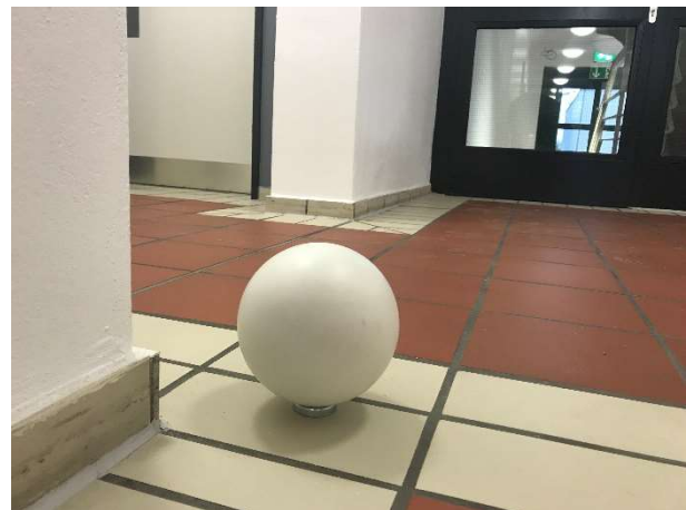
4. ábra: Balra a Faro szkennert, jobbra egy kapcsolópontként használható gömb
