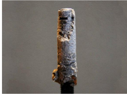
3.11 ábra: Kombinált tönkremenetel
