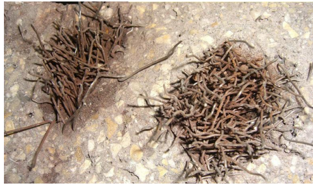
3.27 ábra: Összecsomósodott acélszálak [10]
