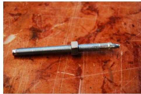
3.18 ábra: Szár szakadása
