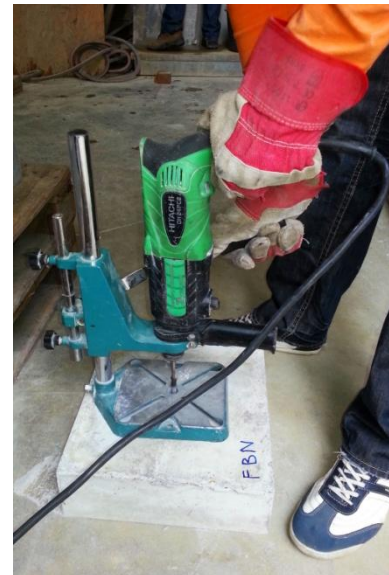
4.6 ábra: Próbatest kifúrása
