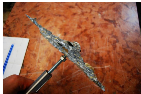
3.19 ábra: Szakadóképus tönkremenetel
