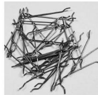
3.25 ábra: Egyenes, hullámos és kampózott végű acélszálak (www10)
