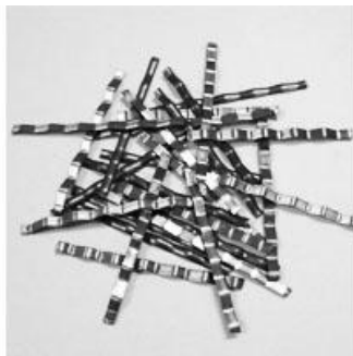
3.25 ábra: Egyenes, hullámos és kampózott végű acélszálak (www10)
