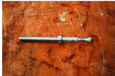
3.17 ábra: Rögzítőelem kihúzódnása
