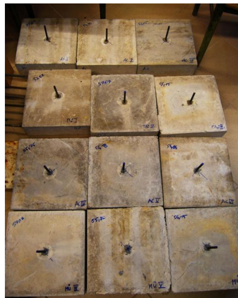
4.3 ábra: Kihúzóvizsgálathoz használt próbatestek az installált rögzítőelemekkel
