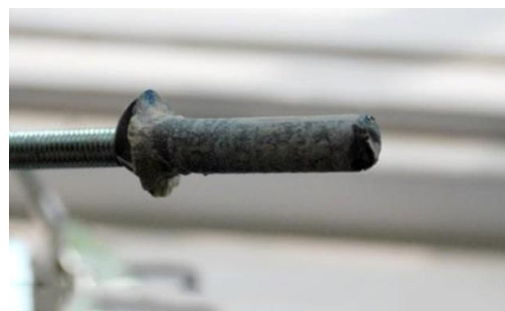
3.10 ábra: Tapadószilárdság kimerülése [21]
