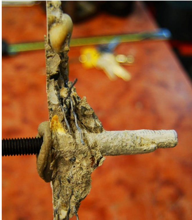
2.1 ábra: A kihúzókérdésnél tapasztalt egyik jellemző tönkremeneteli mód a részleges szakadókúp
