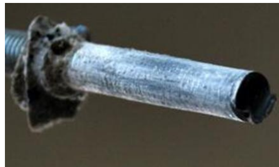
3.9 ábra: Ragasztó elnyíródásos tönkremenetel [21]
