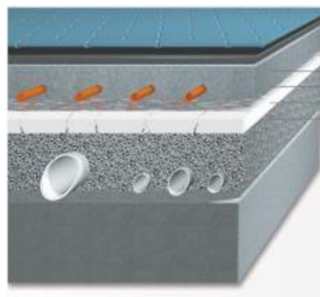
5. ábra PSC alkalmazásai: nem teherhordó hőszigetelő födém (bal) [10], födém rétegrénd PSC kitöltéssel (jobb) [9]
