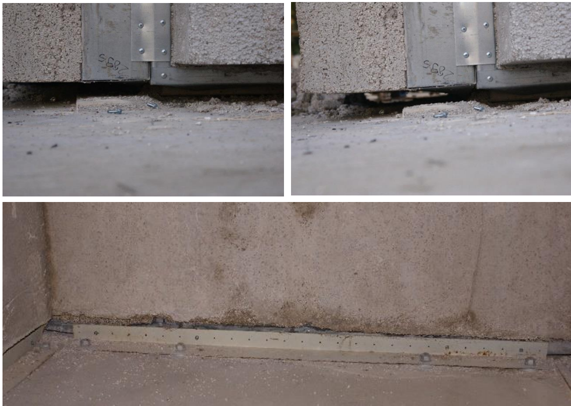
33. ábra T3 jelű épület tönkremenetele megerősített csomóponti kapcsolatok mellett (T3-h3-ult1)
