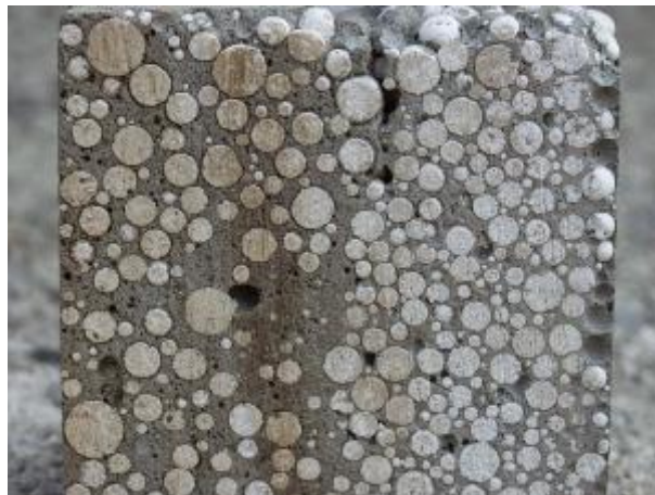
3. ábra Polisztirolbeton metszete [4]
