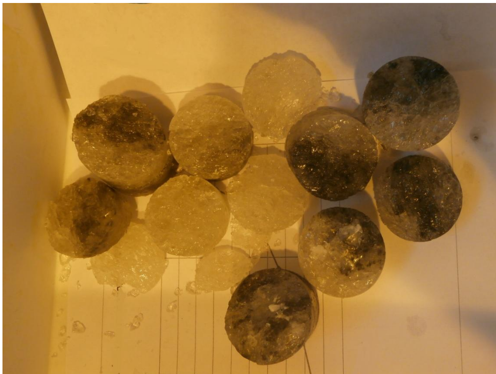
14. ábra – Rétegek mentén szétört próbatetek (III. tömb)
