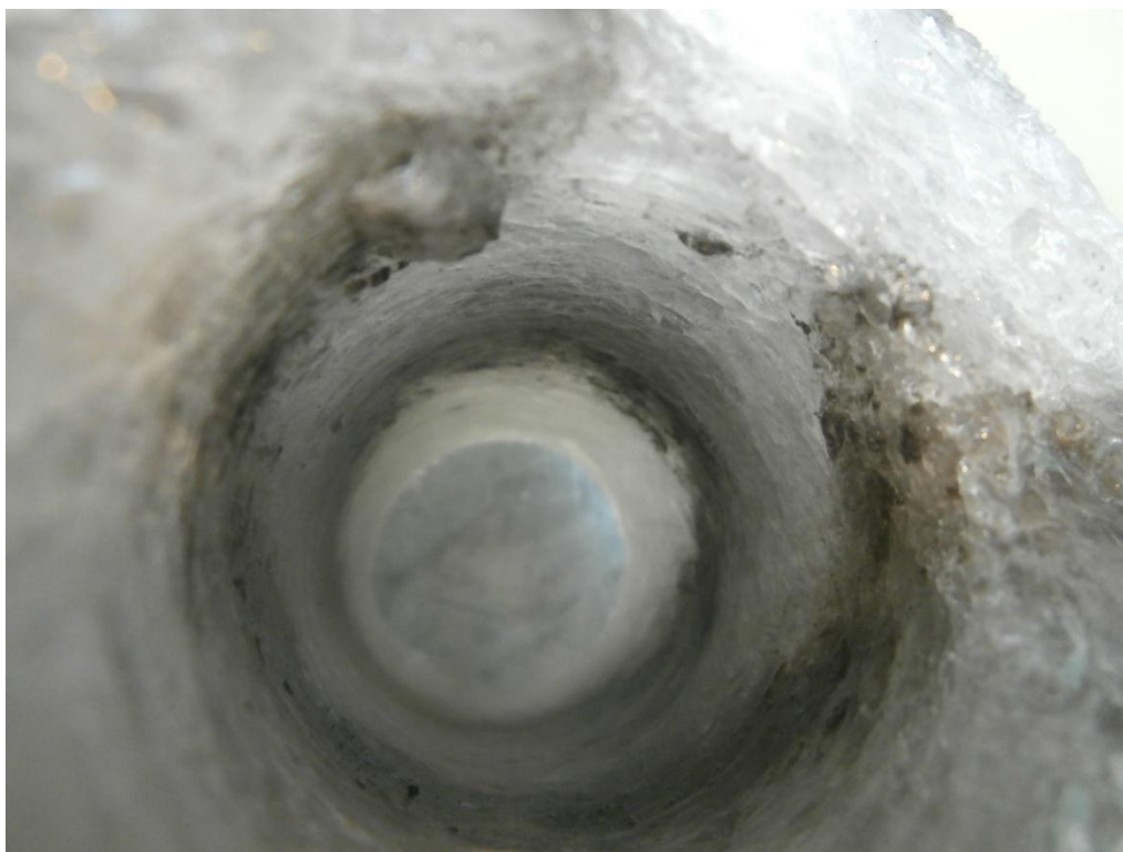
15. ábra – A fúrólukban látható fehér-szürke rétegek váltakozása
