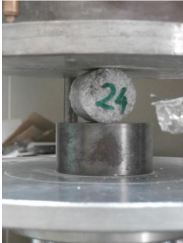
17. ábra – Húzószilárdság mérése
