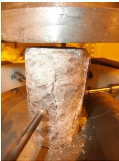
16. ábra – Egyirányú nyomószilárdság mérése
