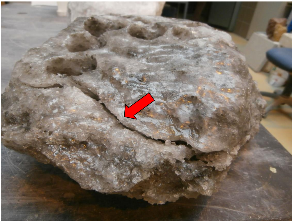
13. ábra – Fúrás közben szétrepedt tömb (V. tömb)
