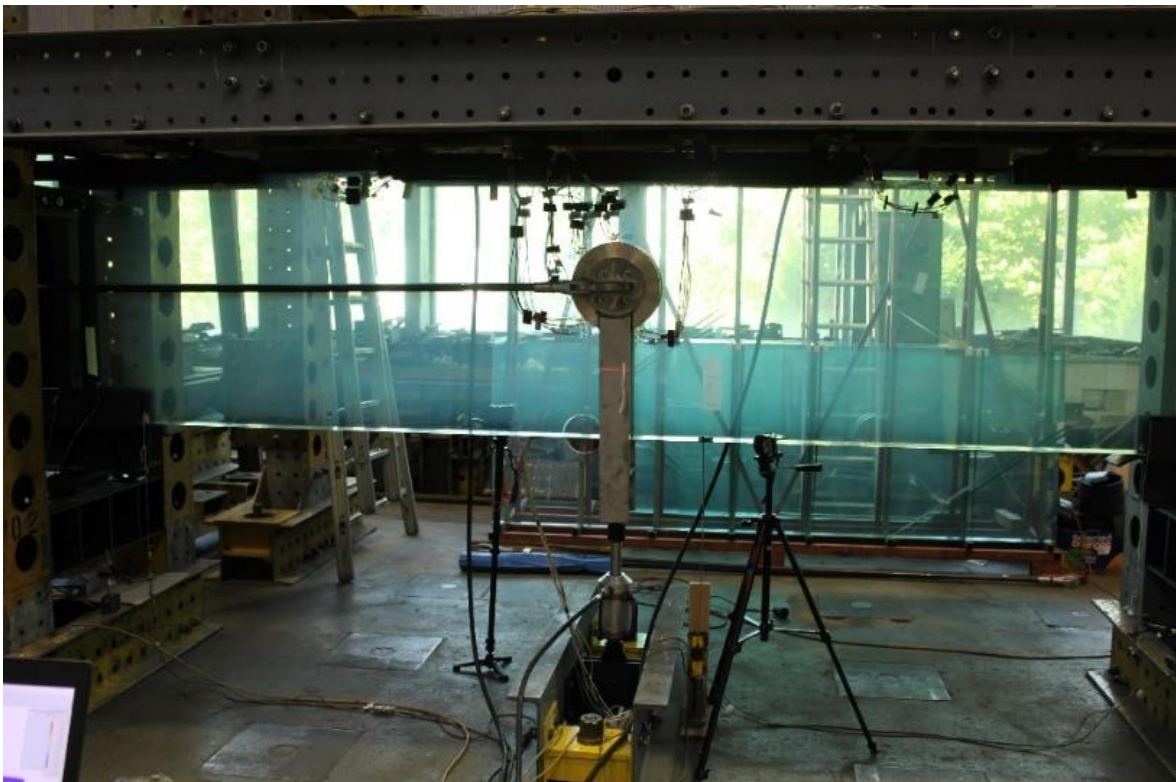
9. ábra: Gerenda kísérleti összeállítása [8]
