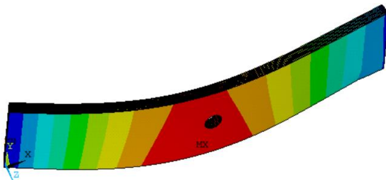
43. ábra: Sajátalak LBA alapján kardosság figyelembevételéhez
