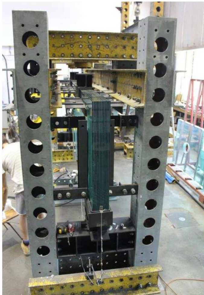
7. ábra: Gerenda oldalirányú megtámasztásai [8]
