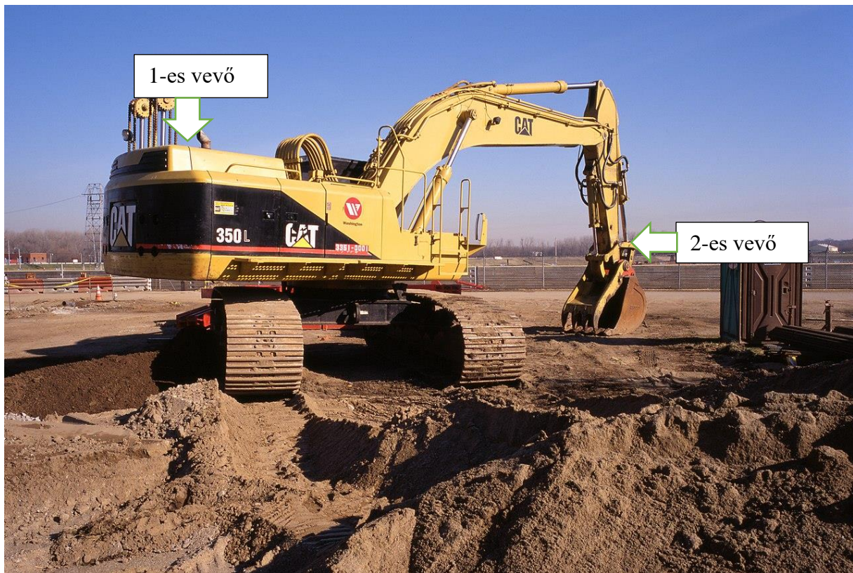
5. ábra Antennák minta elhelyezése egy kanalas kotrógépen (Alden, 2001)
