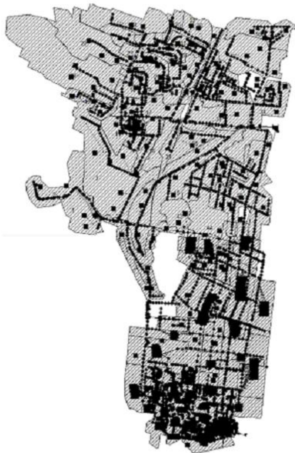
8. ábra. A vizsgált vízgyűjtő terület és az egyesített rendszerű csatornahálózatának SWMM modellje
