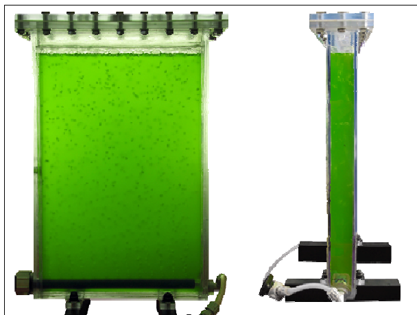
3. ábra Síkreaktor KSD company, Hattingen
