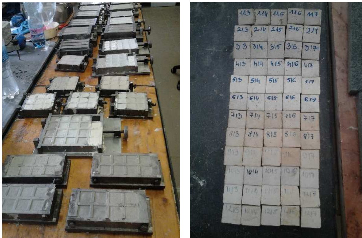
1. ábra: Első fázis során készült próbatetek a BME, Építőanyagok és Mérnökgeológia Tanszék laboratóriumában (2012).
