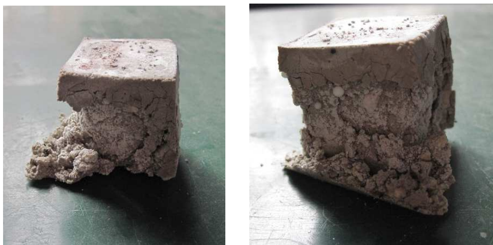
25. ábra: Fagyasztás hatása fagyasztóba kerüléskor vízzel telített próbatesteknél
