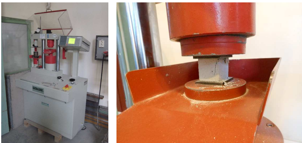
10. ábra: Formtest típusú törő és hajlító gép vizsgált habarcs próbatesttel.
