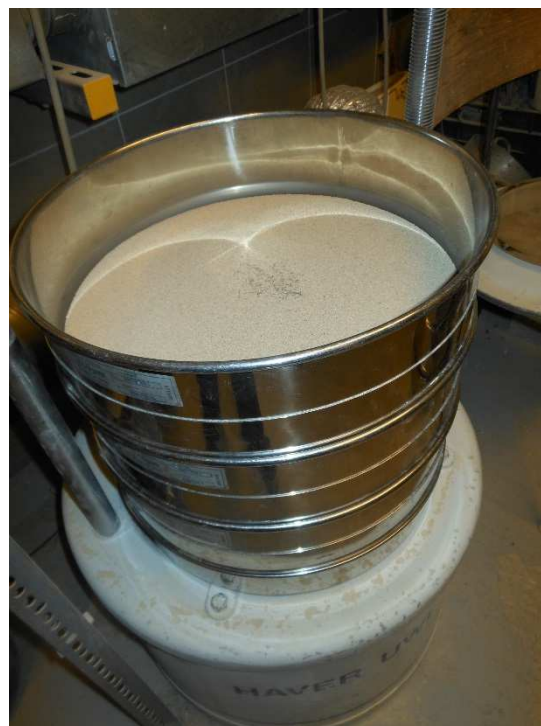
7. ábra: Szitarázó berendezés - szemeloszlás vizsgálathoz a labor hangszigetelt kamrájában.
