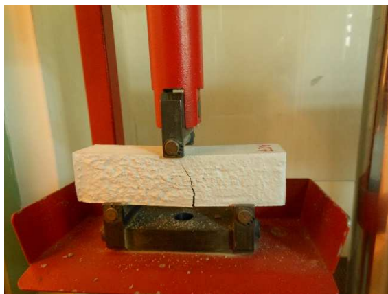
11. ábra: Hajlítóerő mérése habarcs próbatesten
