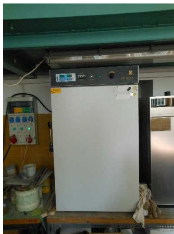
12. ábra: : Nüve típusú, programozható szárítószekrény a laborban
