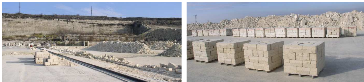
2. ábra: Sósokúti bánya, kőfejtés. Beszerezhető hasábok mérete: 20x20x40 cm 3 .
