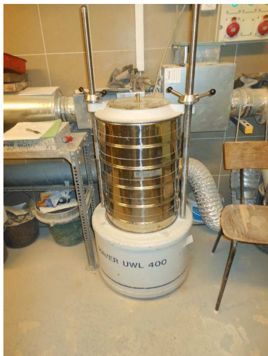
7. ábra: Szitarázó berendezés - szemeloszlás vizsgálathoz a labor hangszigetelt kamrájában.
