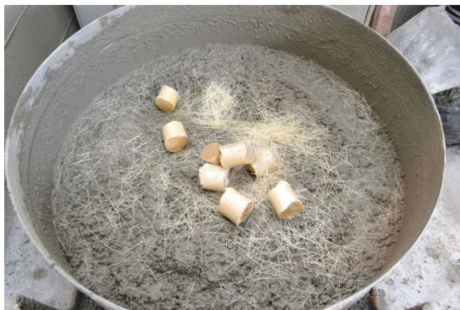
5.1. ábra: Concrix szálak adagolása a betonhoz
