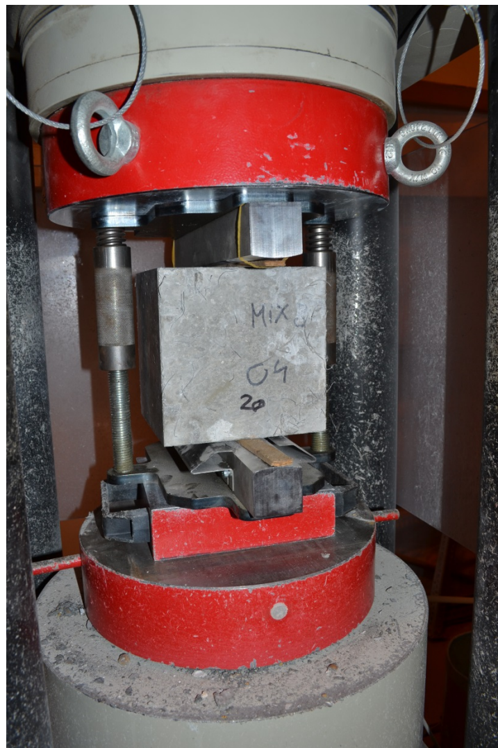
5.4. ábra: ALPHA-3-3000 S típusú törőgép, szabványos törőfejjel az Építőanyagok és Mérnökgeológia Tanszék Laboratóriumában
