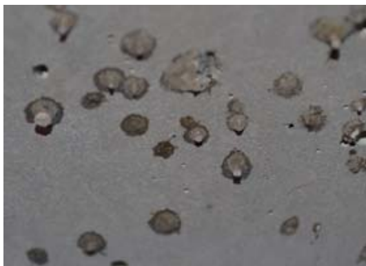
6.1. ábra: MIX7 keverékből készült próbatest 300 °C hőterhelés után
