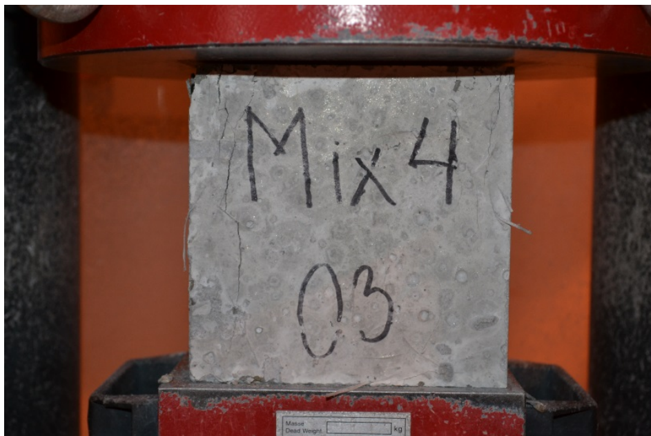
5.3. ábra: Nyomószilárdság vizsgálat ALPHA-3-3000 S típusú törőgéppel az Építőanyagok és Mérnökgeológia Tanszék Laboratóriumában
