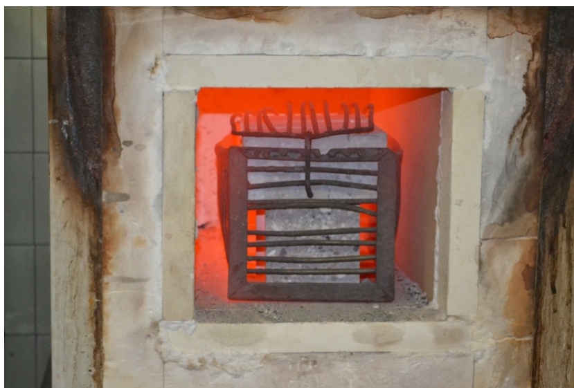
5.2. ábra: 800 °C-os kemence próbatestekkel az Építőanyagok és Mérnökgeológia Tanszék Laboratóriumában
