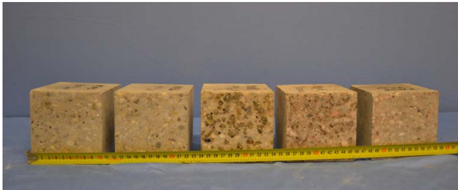
6.3. ábra: 100 mm élhosszúságú, vágott kockák hőterhelést követően
