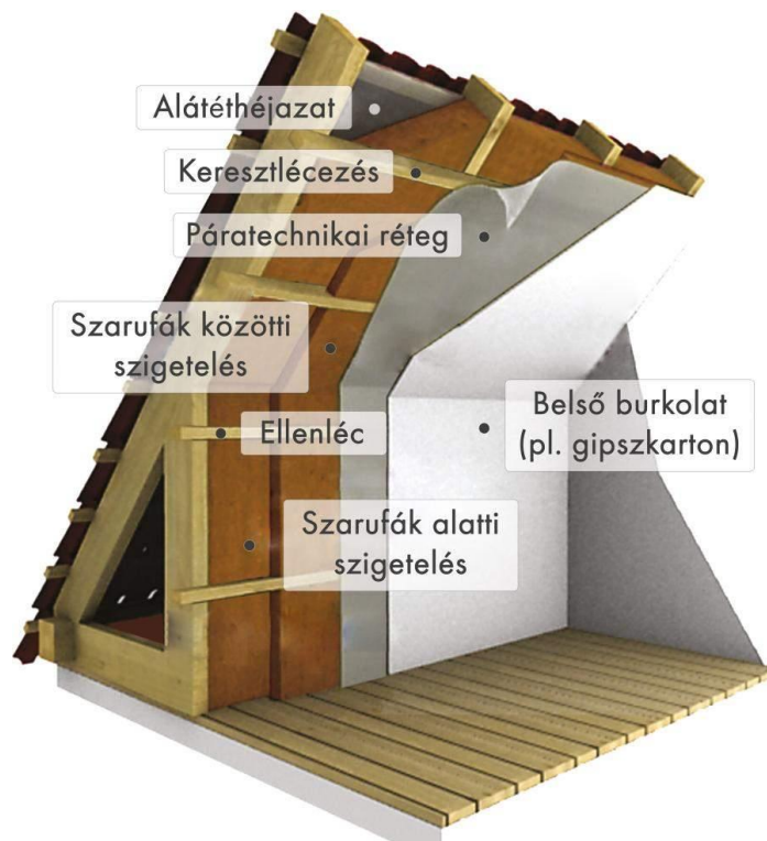
4. ábra: Hőszigetelés kialakítása [9]
