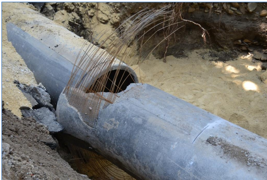
2.11. ábra: Sentab cső héjkitörése (Kép készült: 2012. 07. 02.)
