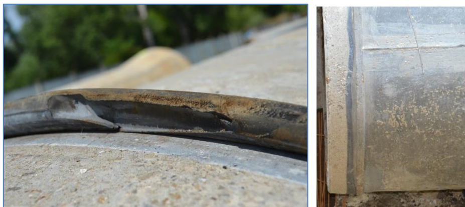
2.12. ábra: Sentab cső tömítőgyűrűjének tönkremenetele (Bal oldali kép készült: 2013. 07. 17., jobb oldali kép készült: 2012. 07. 02.)
