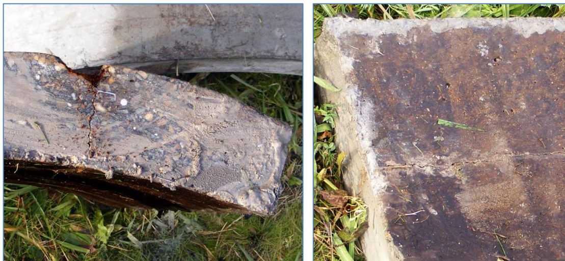
2.13. ábra: Sentab cső csőlyukadásos tönkremeneteli helyénél kivett csődarab oldalról és a cső belseje felől nézve (Kép készült: 2010. 11. 04.)
