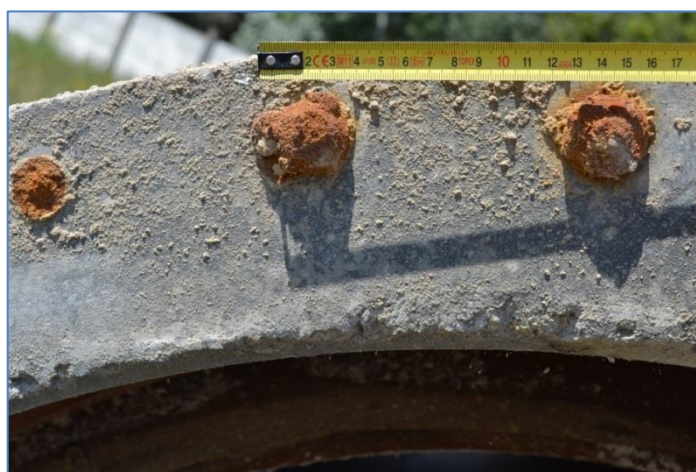
6.1. ábra: Sentab cső bütüs felületén észlelt rozsdafoltok (Kép készült: 2013. 07. 17.)
