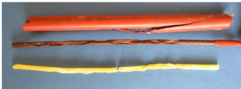
5.4. ábra: A feszítőbetét viasz másának készítése (legfölül látható a feszítőbetét körbeöntésekor keletkezett sablon, középen a mintavételhez használt feszítőbetét, míg legalul a feszítőhuzal viaszából készült mása, kép készült: 2012. 08. 08.)
