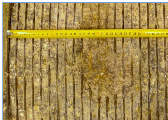
6.34. ábra: Vizsgált minta CT modellje és betonfedés eltávolítását követő képe (CT modellt készítette: Földes Tamás, betonfedés feltárását én végeztem: 2012. 11. 23-án)
