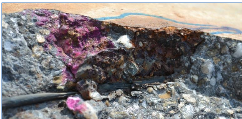
6.17. ábra: Repedés felülete nem színeződött el a fenolftalein oldat felhordása után (Kép készült: 2013. 07. 18.)
