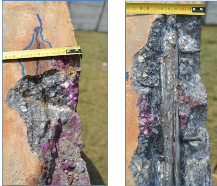
6.26. ábra: Rozsdatermék alatt talált repedés környezetének feltárása (Képek készültek: 2013. 07. 18.)
