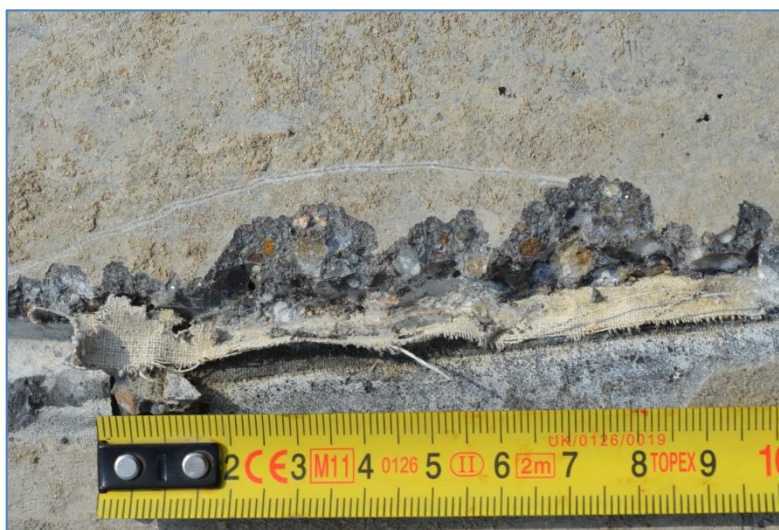
2.4. ábra: Fb-10-1200 típusú Sentab cső zsaluillesztésénél használt tömítő szalag (Kép készült: 2013. 07. 18.)
