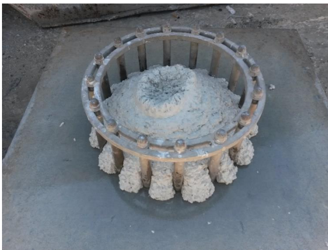
36. ábra: Fékező gyűrűs terület vizsgálat során a szétterülő öntömörödő beton
