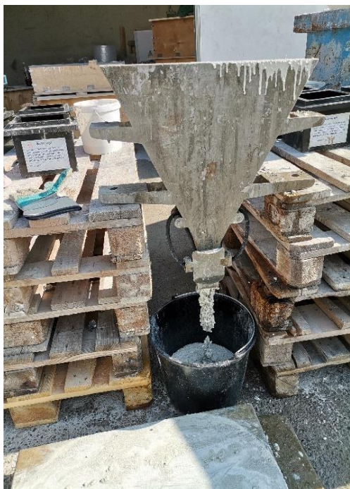
34. ábra: Tölcséres kifolyási idő mérés
