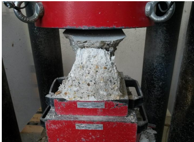
37. ábra: Kocka alakú próbatesten végzett nyomószilárdság vizsgálat
