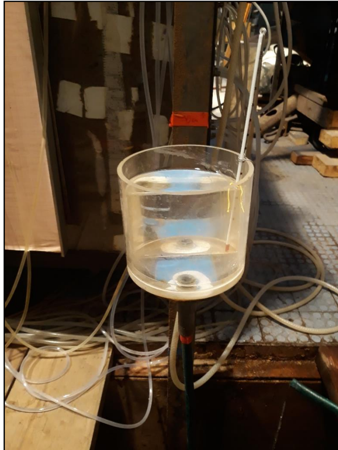
6. kép: Alsó peremként szolgáló bukó és hőmérője
