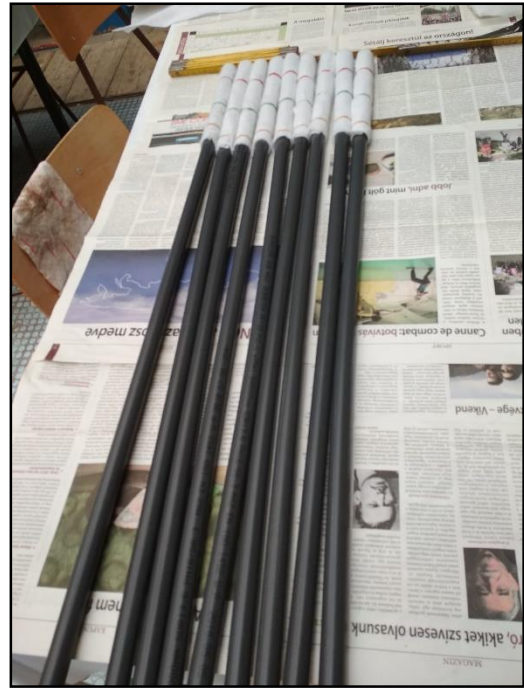
2. kép: Megfigyelőkutak perforált szakaszának geotextíliával való borítása
