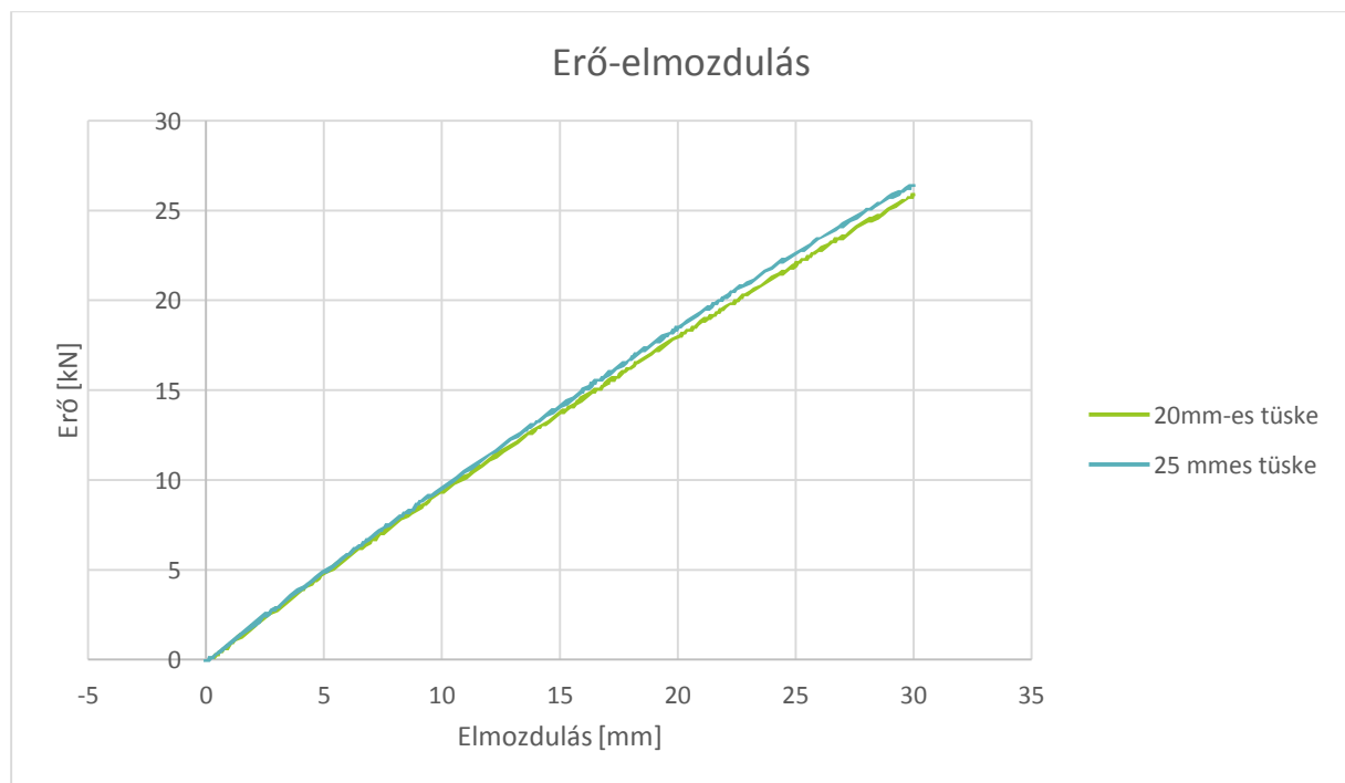
88. ábra: erő elmozdulás diagramok a tüske átmérő változtatását bemutatva
