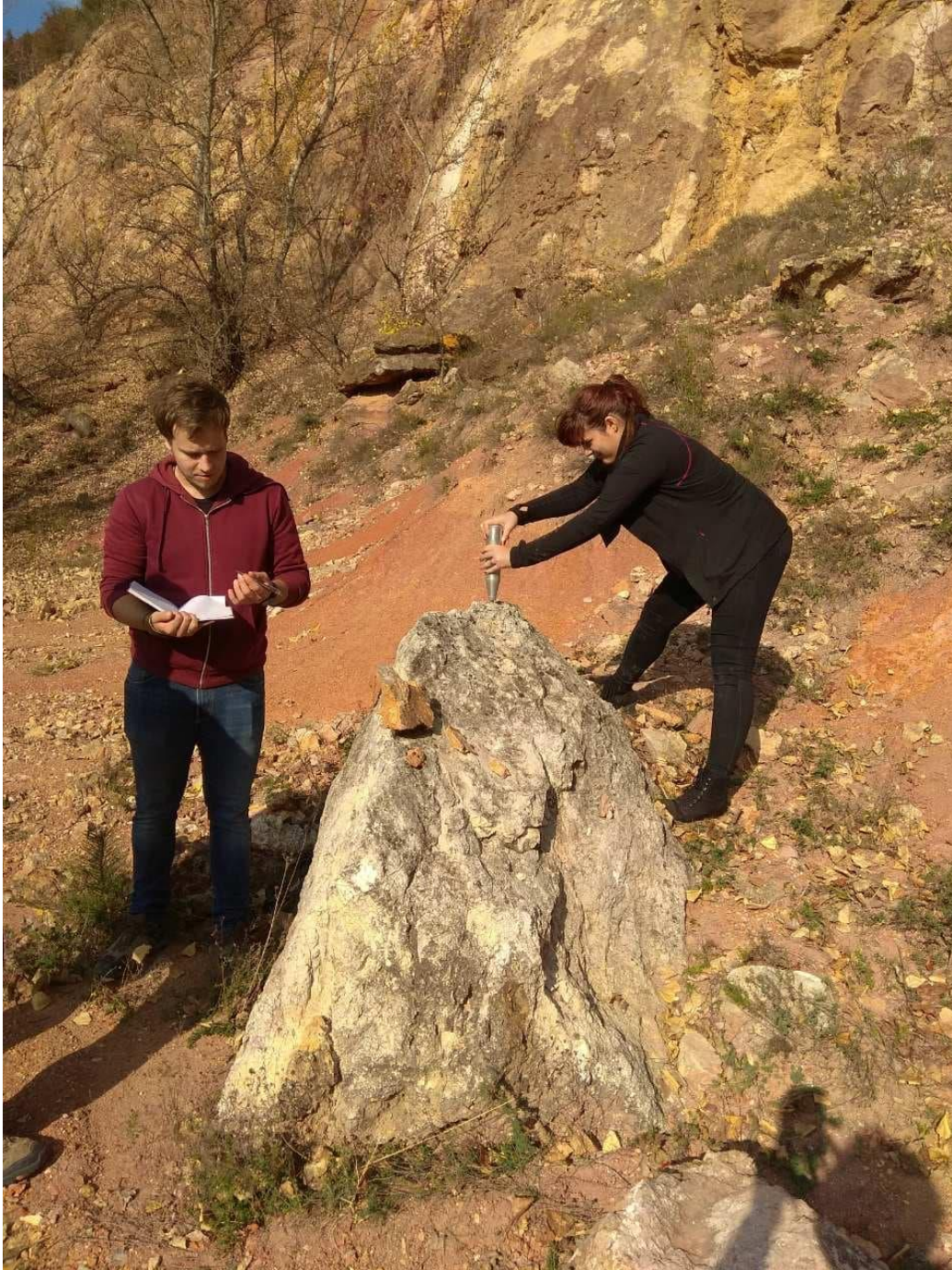
10. kép Helyszíni L-típusú Schmidt kalapácsos mérés
