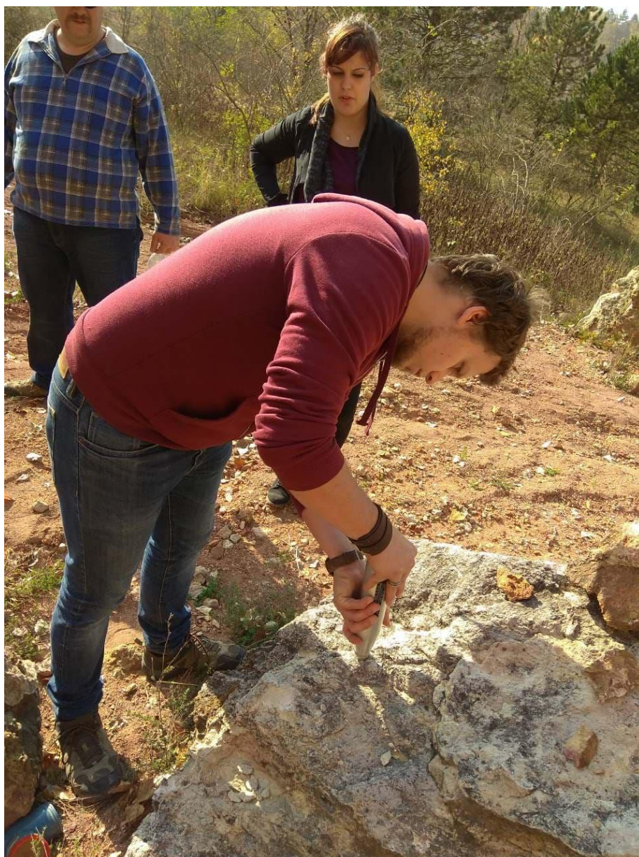
2. kép Mérés L-típusú Schmidt kalapáccsal
