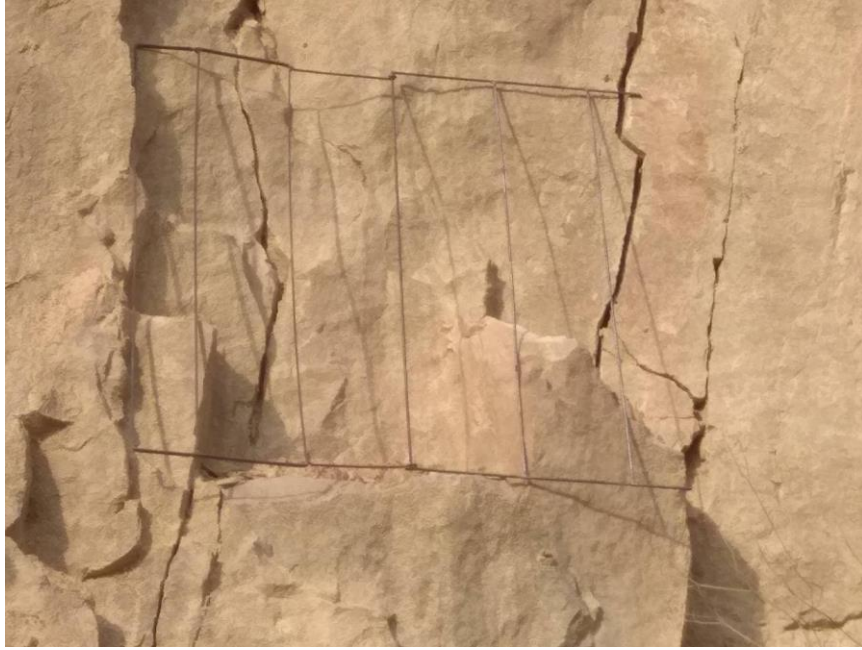
4. kép Csobánka Csúcs-hegyi kőfejtő RQD érték meghatározása
