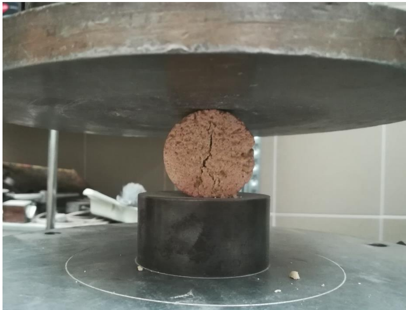
11. ábra: Közvetett húzószilárdság mérése
