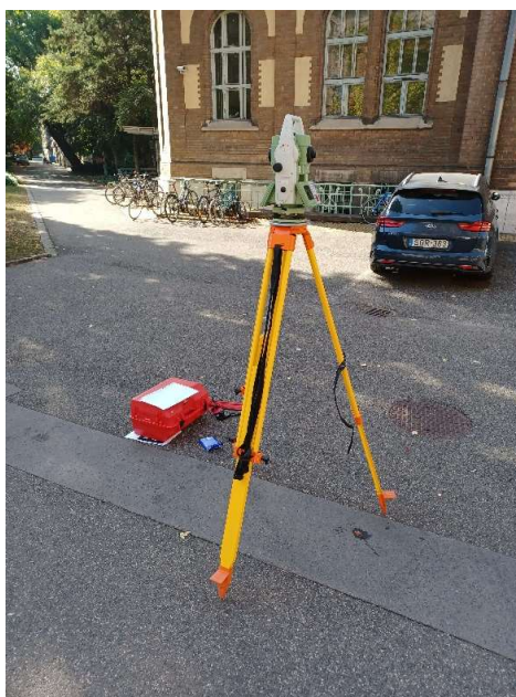
12. ábra Felállított Leica TS15i robot mérőállomás
