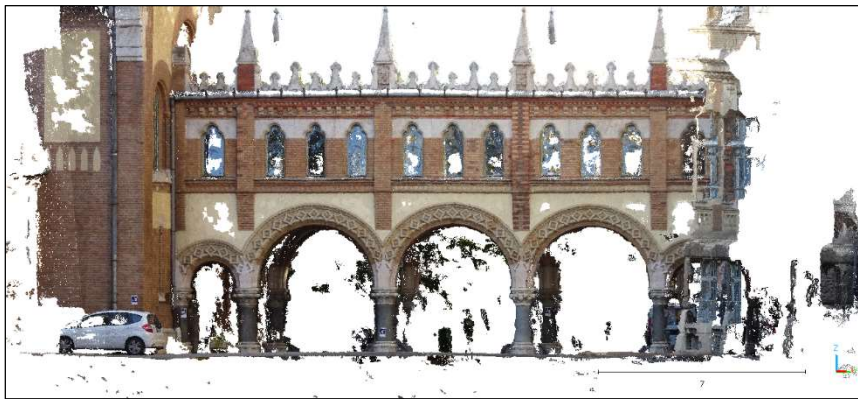
17. ábra WebODM, távoli képekből előállított pontfelhő
