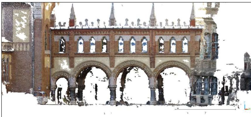
18. ábra WebODM, középtávról készült képekből előállított pontfelhő
