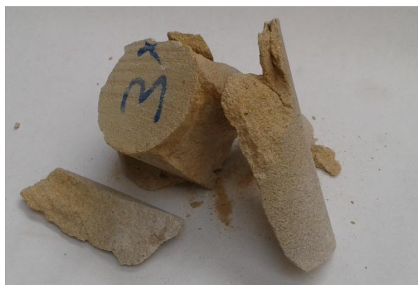
24. ábra. A próbatétel jellegzetes tönkremeneteli képe
