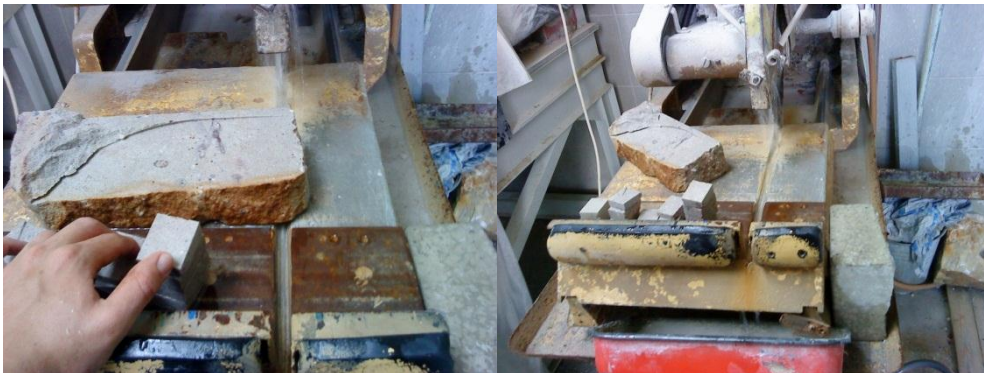
15. ábra. A kőtömbök megfelelő méretűre darabolása, vizes kővágóval
