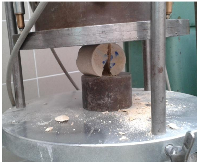
26. ábra. Vizsgálati elrendezés és a tönkremeneteli kép
