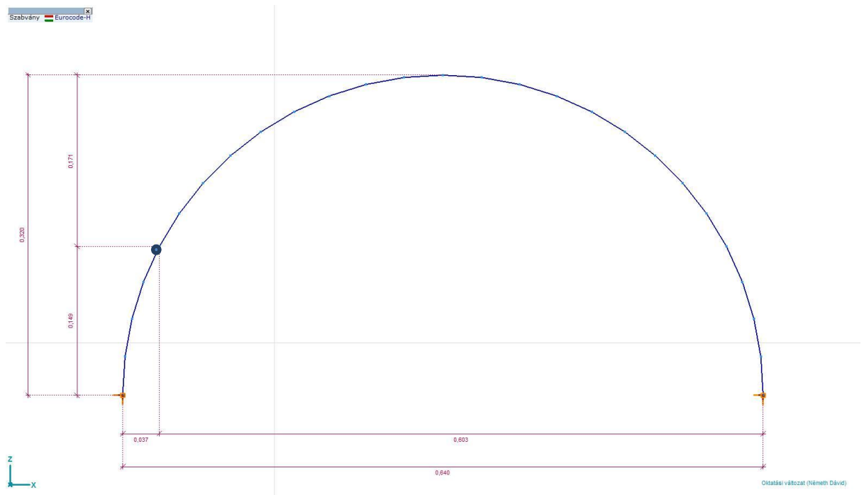
40. ábra. Az Axisban feltételezett statikai váz
